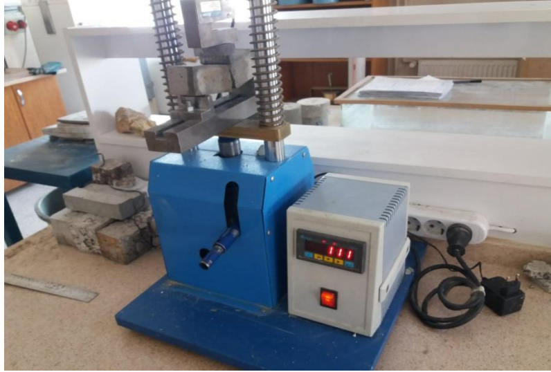
Resim 3.9 Tamir harçlarının Eğilme dayanımı deneyi.
