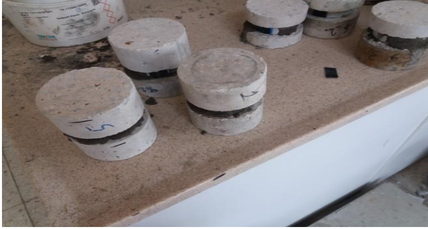
Resim 3.5 Tamir harçlarının yapışma deneyleri için hazırlanan numuneler.
