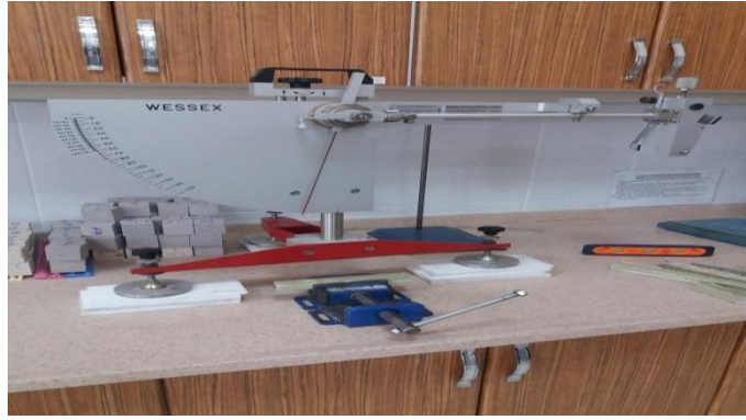
Resim 3.14 Sürtünme (kayma) direnci deneyi.
