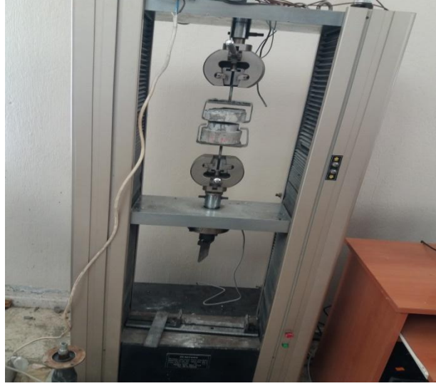
Resim 3.12 Tamir harçları aderans gerilmesi deneyi.
