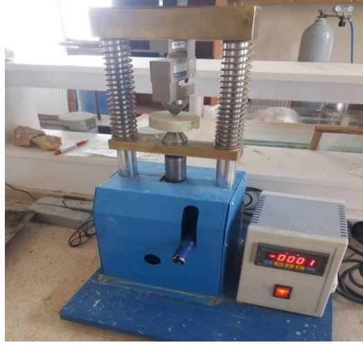
Resim 3.13 Tamir harçlarının noktasal yükleme deneyi.
