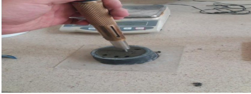
Resim 3.7 Tamir harçlarının penetrasyon deneyi.
