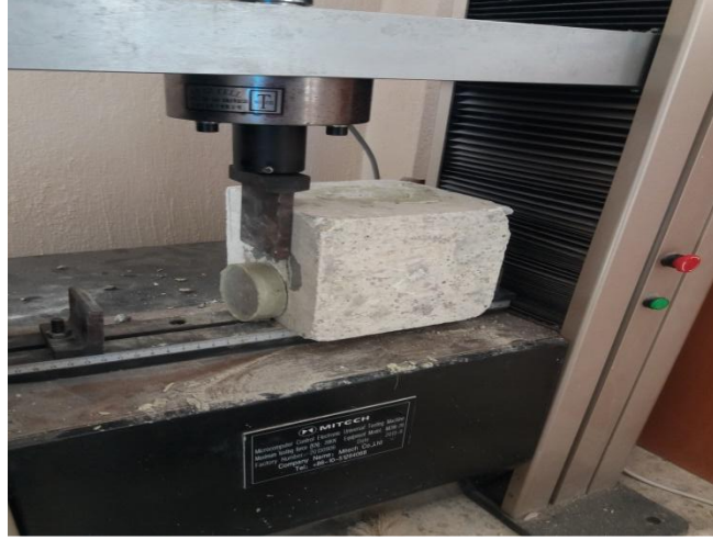
Resim 3.11 Tamir harçları kayma gerilmesi deneyi.
