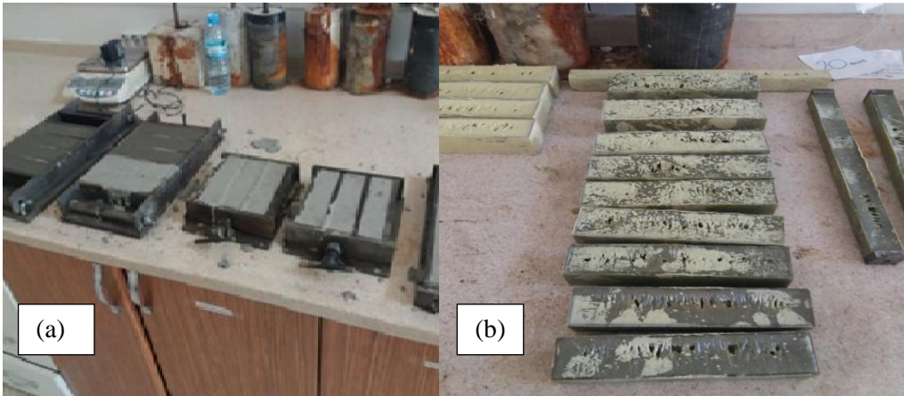
Resim 3.3 Eğilme ve basınç deneyleri için hazırlanan numuneler (a) Tamir harcı; (b) Sülfür harcı.
