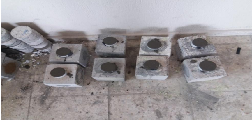
Resim 3.4 Tamir harçlarının kayma deneyleri için hazırlanan numuneler.
