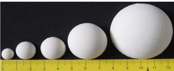
Şekil 1. Çalışmalarımızda asıltı döküm yöntemiyle üretilmiş yarıküresel ince kabuk piezoseramikler.
