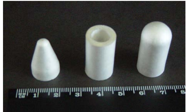
Şekil 3. Sinterlenmiş ve elektrotlanmış konik, silindirik ve tüp formunda ince kabuk piezoseramik dönüştürücüler.
