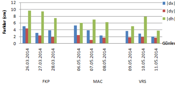
Şekil 7. Ölçü değerleri ile bilinen değerler arasındaki maksimum farklar
