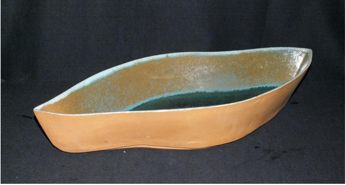
Resim 50. DÇ3 no'lu döküm çamurundan üretilmiş, firuze renkli sır uygulanmış form, 1160 °C, 2013.
