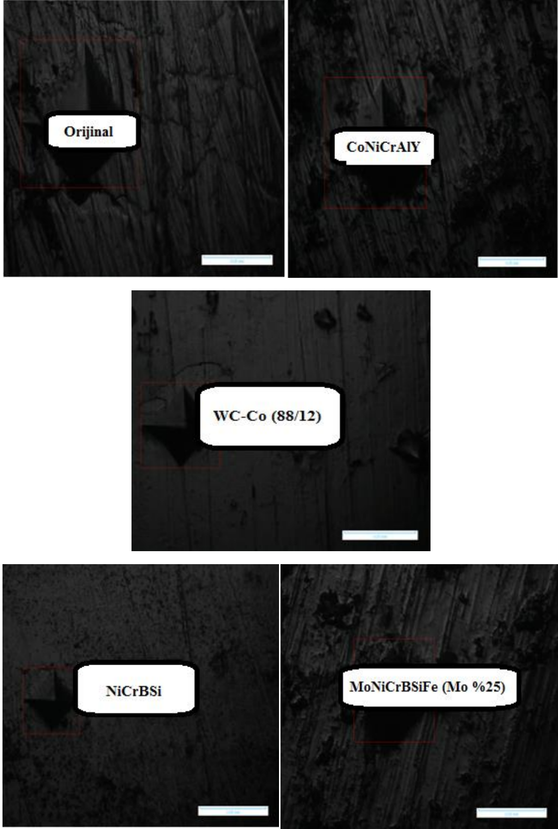
Şekil 4.3 Sürtünme esnasında balataların fren diskleri yüzeyinde oluşturduğu görüntüler.
