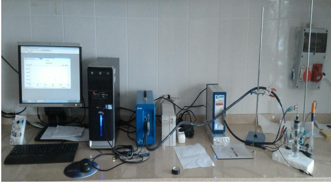
Resim 3.10 Korozyon analizi cihazı ve yardımcı elemanları.
