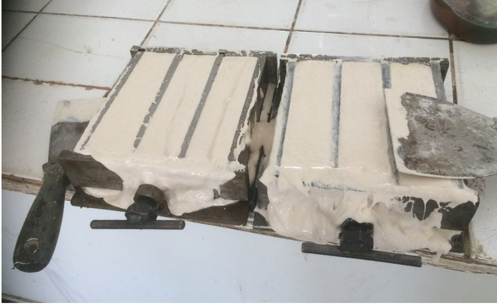
Resim 3.4 40x40x160mm prizmatik üçlü çimento kalıbı ile şekillendirilen alçılar.
