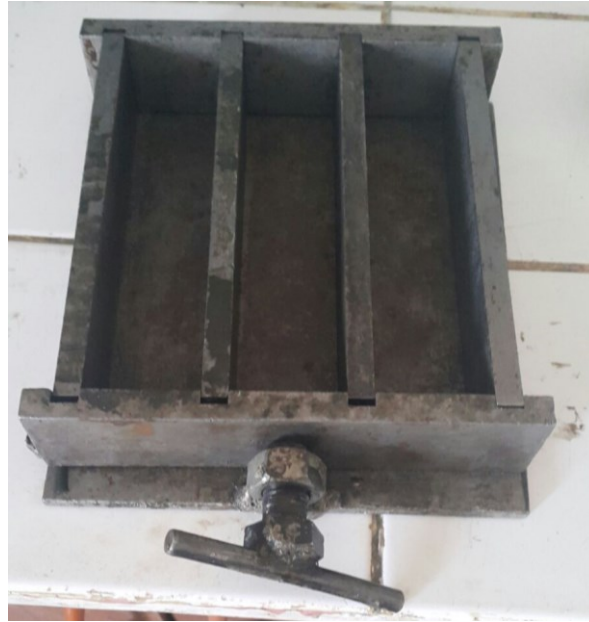
Resim 3.3 40x40x160mm prizmatik üçlü çimento kalıbı.
