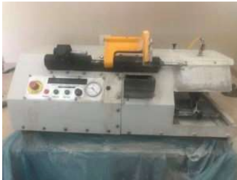
Resim 3.3 İnce kesit hazırlama ve kesit inceltme makinesi.
