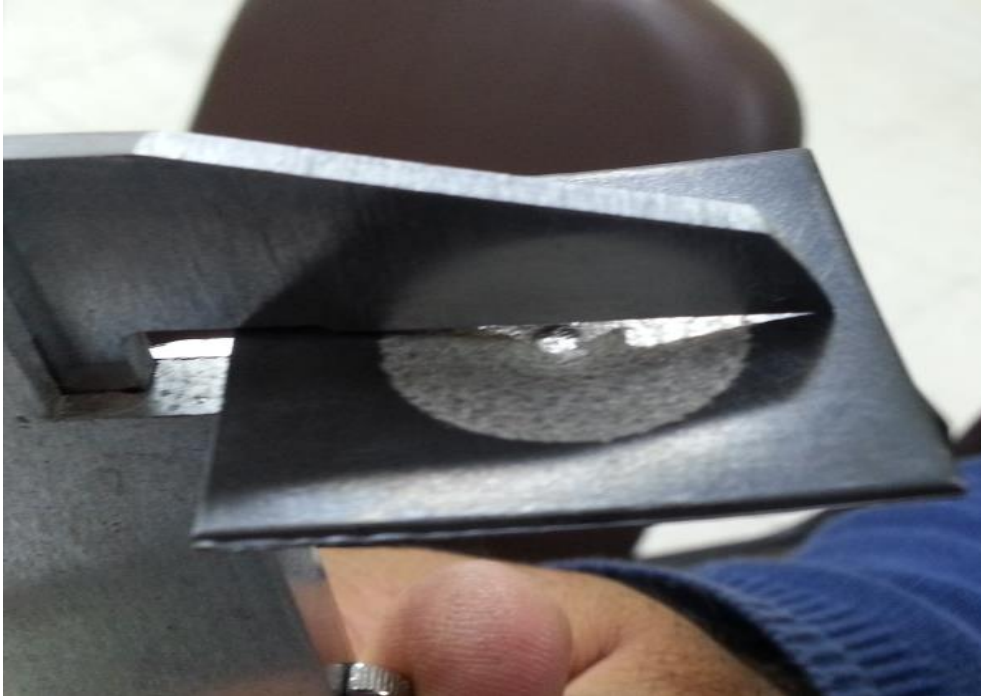
Resim 4.22 AISI 1008 Çeliđi Kaplama Yüzeyi Serbest Deformasyon İz Geniřliđi.
