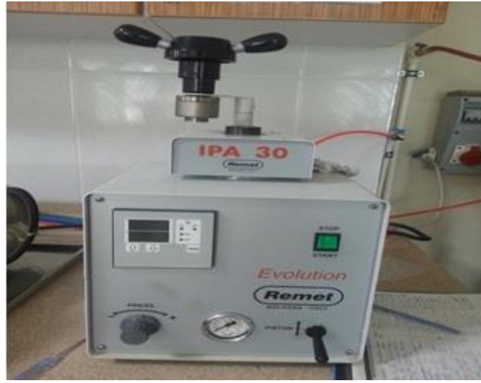
Resim 3.8 Numunelerin Sıcak Kalıplama Bakalite Alınma İşlemi.
