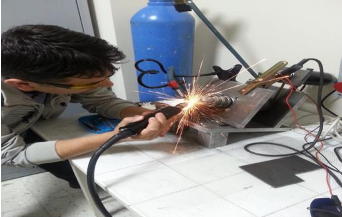
Resim 2.2 ESD Yöntemi ile AISI 1008 Malzeme Yüzeyi Tungsten (W), Tungsten Karbür(WC) ve Alaşımli Çelik ile Kaplama Yöntemi.
