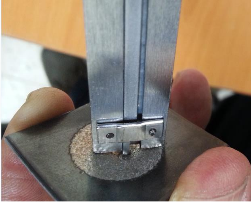
Resim 4.23 AISI 1008 Çeliği Kaplama Yüzeyi Serbest Deformasyon İndent Derinliği.
