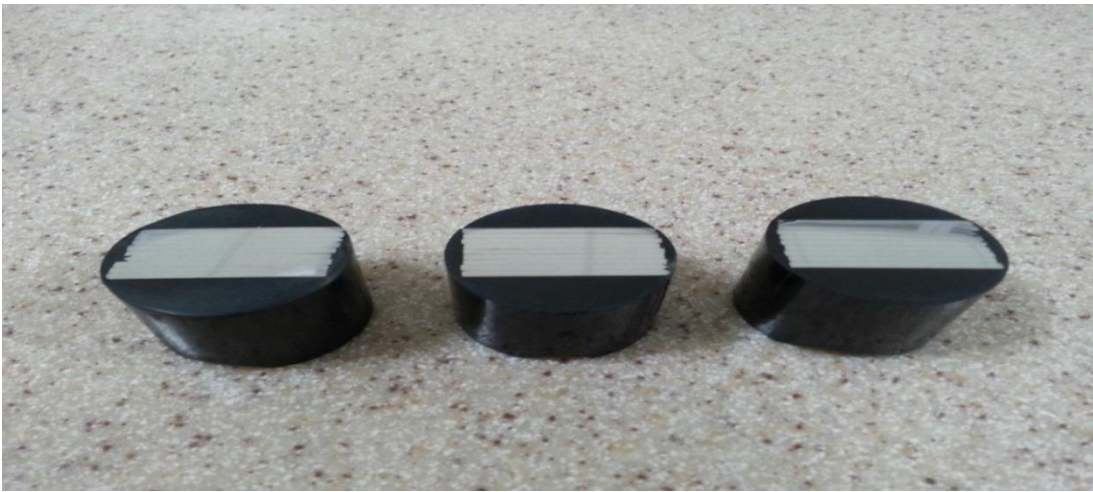
Resim 3.9 Numunelerin Sıcak Kalıplama Bakalite Alınma.
