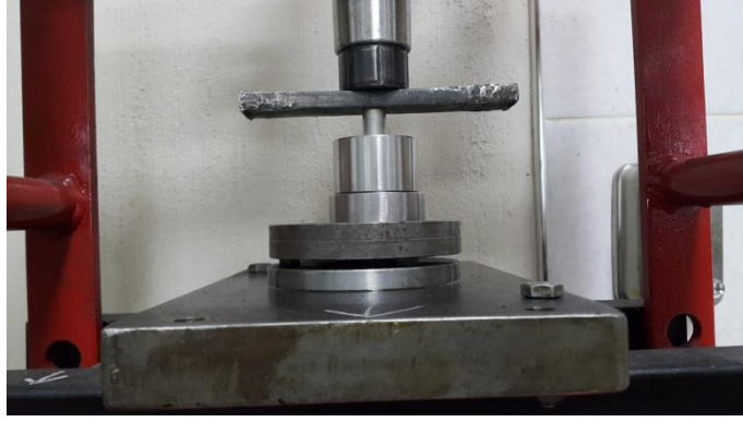
Resim 3.3 Hidrolik preste tablet haline getirme.
