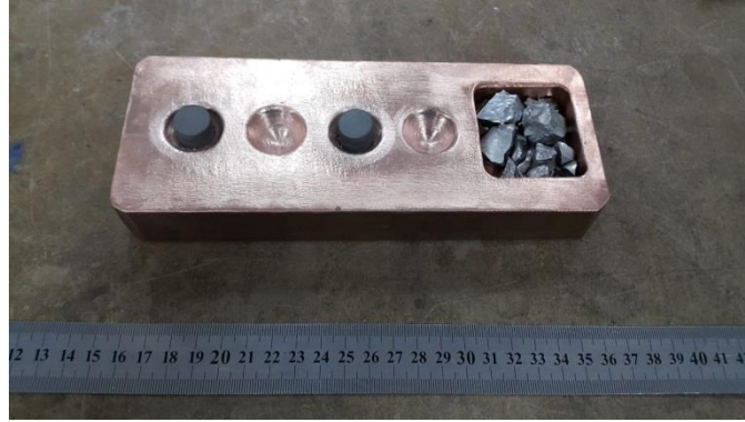
Resim 3.6 Ergitme öncesi master alaşımlar ve fedai alaşım.
