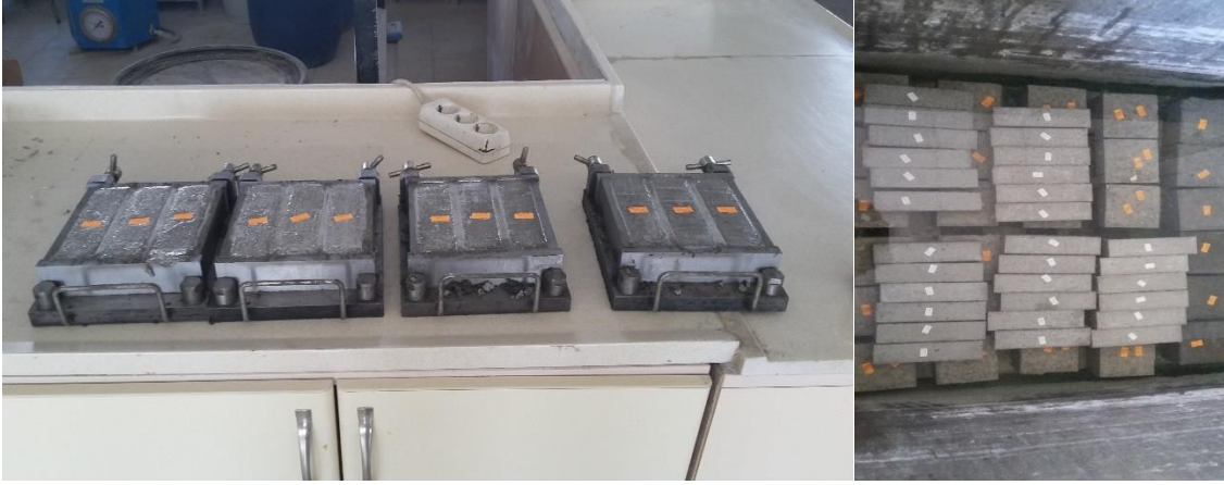
Resim 3.7 Kalıplara dökülmüş numuneler (solda) ve kür tankındaki numuneler (sağda).
