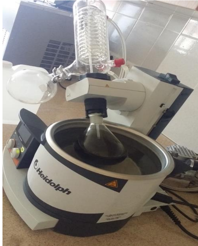
Resim 3.2 Rotary evaparatörde alkolün uçurulması.
