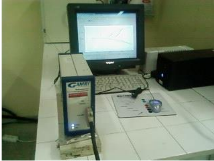
Resim 3.1 Bilgisayar kontrollü potansiyostat-galvanostat sistemi deney düzeneği
