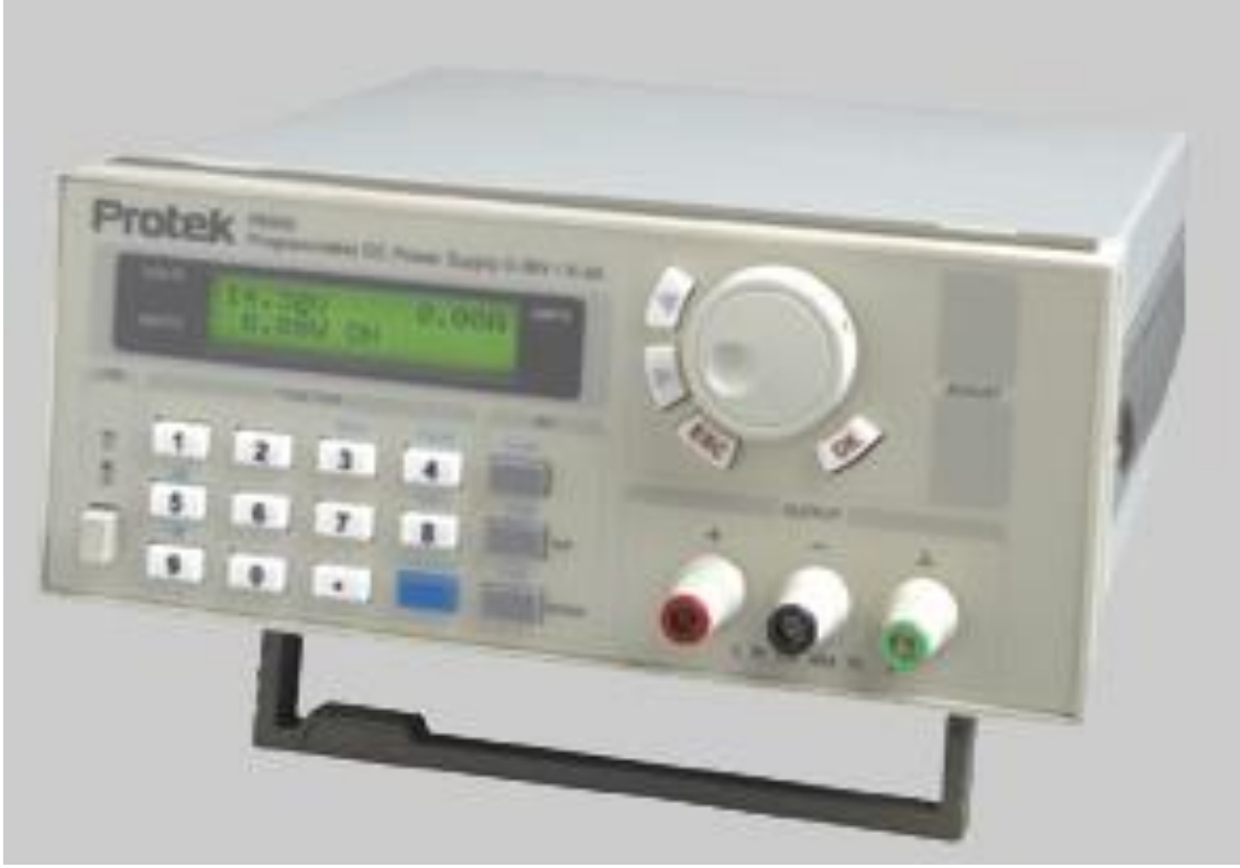
Resim 3.4 Protek P6000 programlanabilir dc güç kaynağı.
