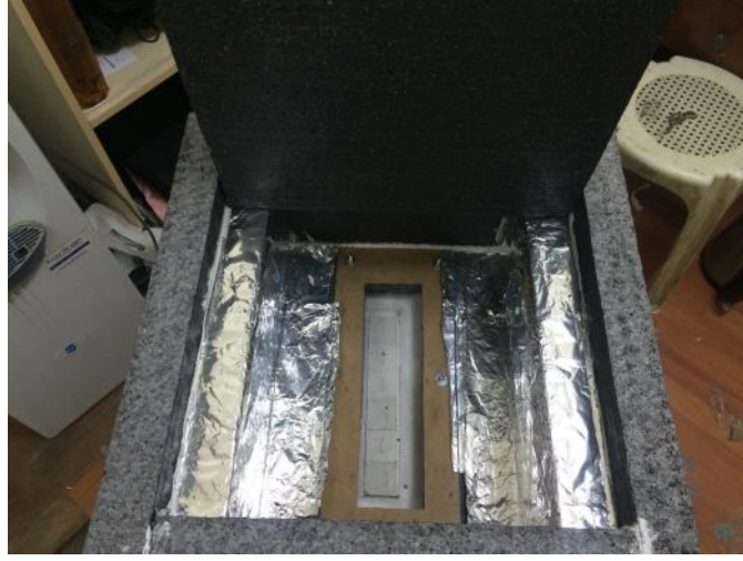
ekil 3.25 So utma kabini tasarımı a amaları - Kabin içi folyo kaplanması.
