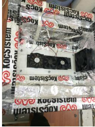
ekil 4.2 Araç içi kabinin soğutma kabine montajı – Soğutma kabini içi.
