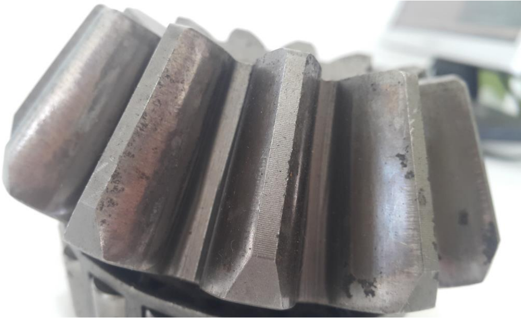
Şekil 4.18 Test Sonrası Pinyon dişli görüntüsü.
