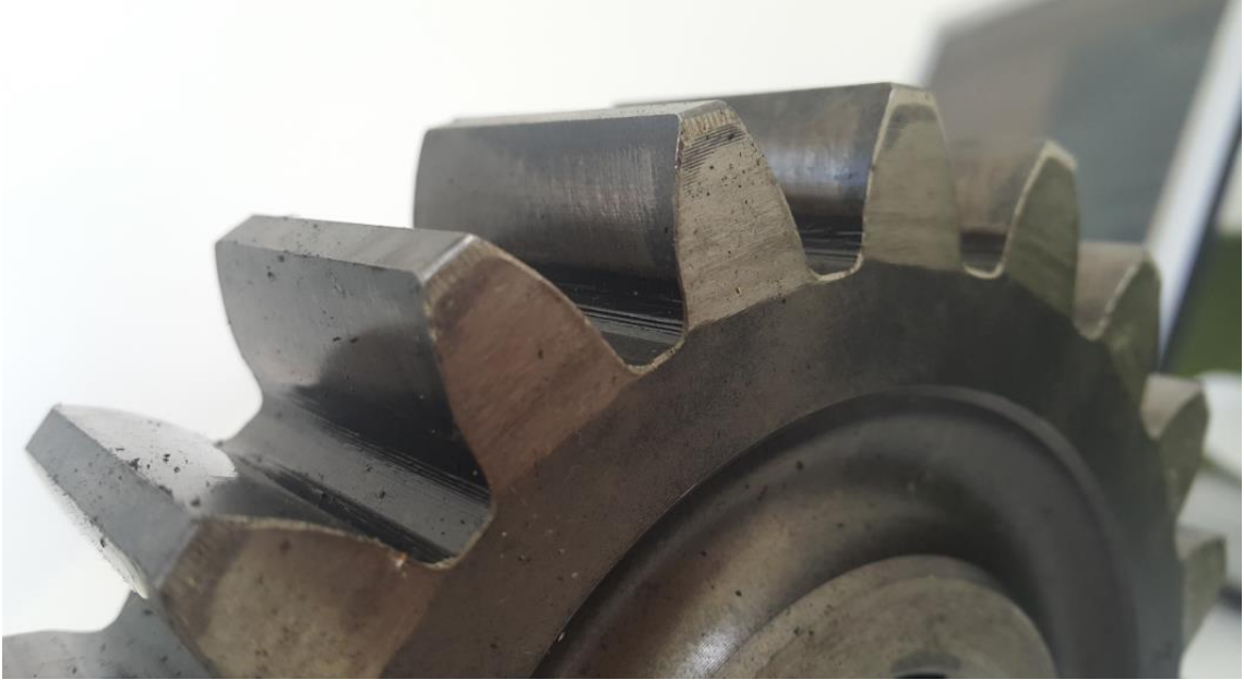
Şekil 4.20 Test sonrası Vites dişlisi görüntüsü.
