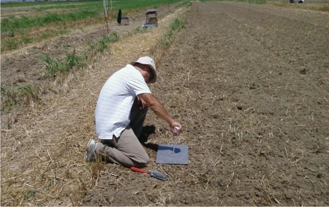
Şekil 3.13 Toprak işleme derinliğinin ölçümü.
