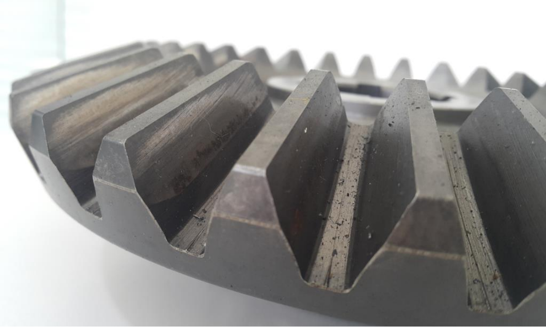
Şekil 4.22 Test sonrası Ayna dişlisi görüntüsü.
