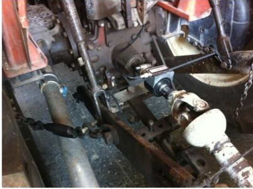
Şekil 3.12 Torkmetre traktör bağlantısı görünümü.
