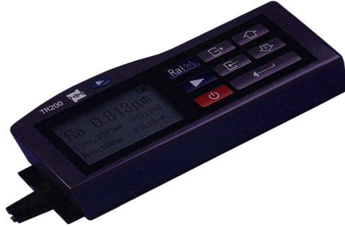
Resim 3.10 AKÜ-DAL’ da ki Time TR 200 marka pürüzlülük ölçüm cihazı.
