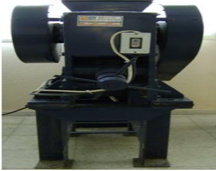
Resim 3.4 AKÜ Maden Mühendisliği Cevher Hazırlama ve Zenginleştirme Laboratuvarında bulunan Macit Makine marka çeneli kırıcı.
