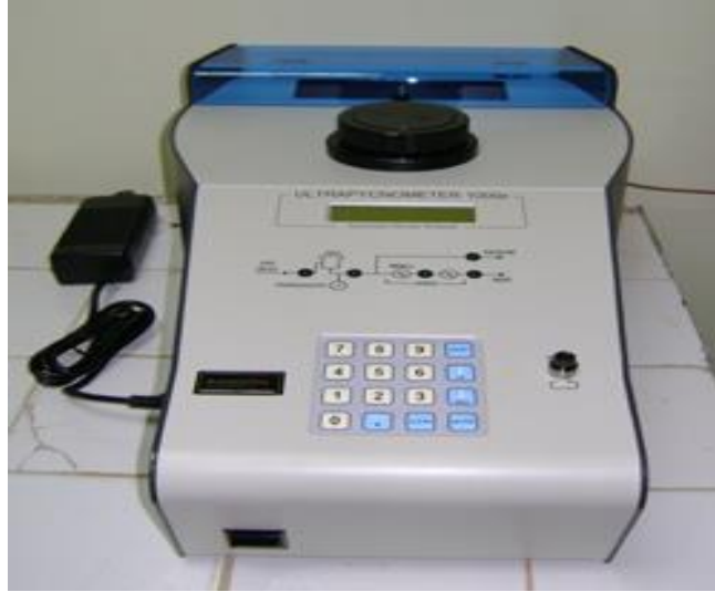
Resim 3.8 AKÜ-DAL' daki Quantachrome Ultrapycnometer marka helyum piknometresi.
