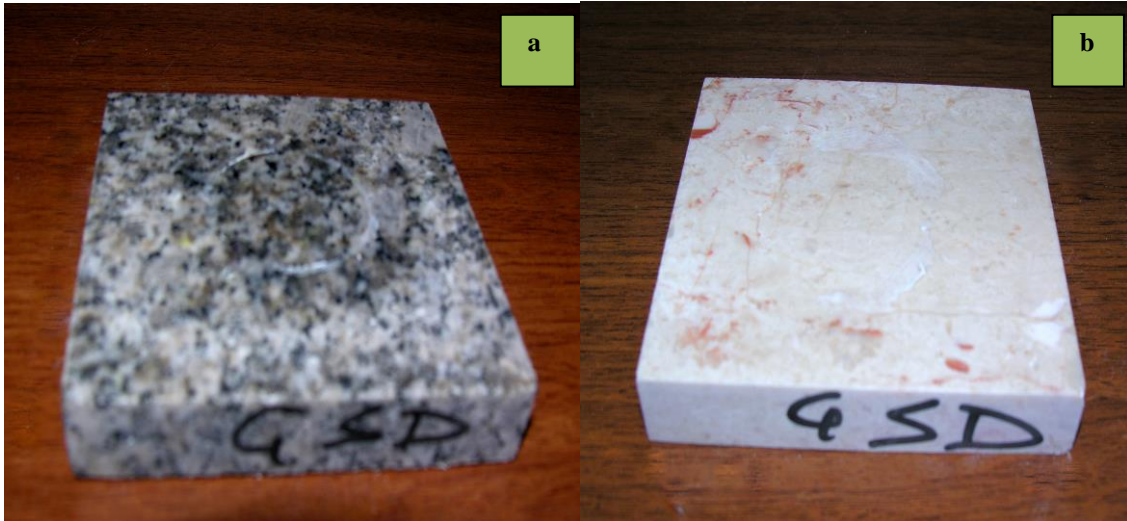
Şekil 4.105 840 saat süre boyunca %100 derişimli çamaşır suyu kimyasalına temas eden granit numunesi (a); 840 saat süre boyunca %100 derişimli çamaşır suyu kimyasalına temas eden mermer numunesi(b).
