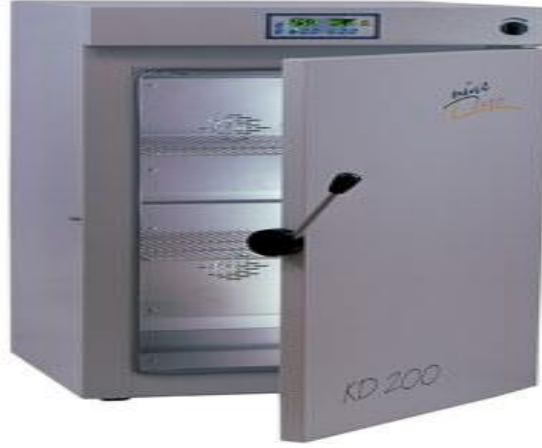
Resim 3.2 AKÜ-DAL’ da bulunan Nüve KD 200 marka etüv.
