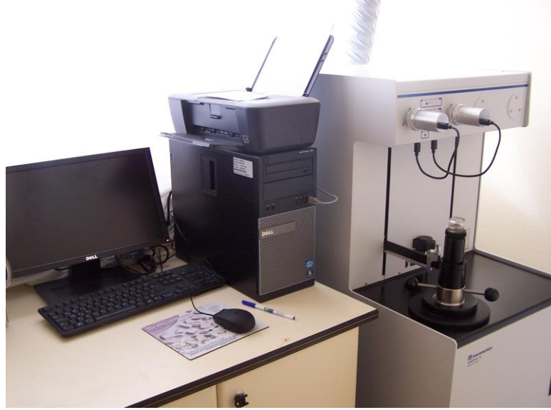
Resim 3.9 AKÜ-TUAM’ daki Micromeritics Auto Pore IV 9500 V1.09 marka cıva porozimetre cihazı.
