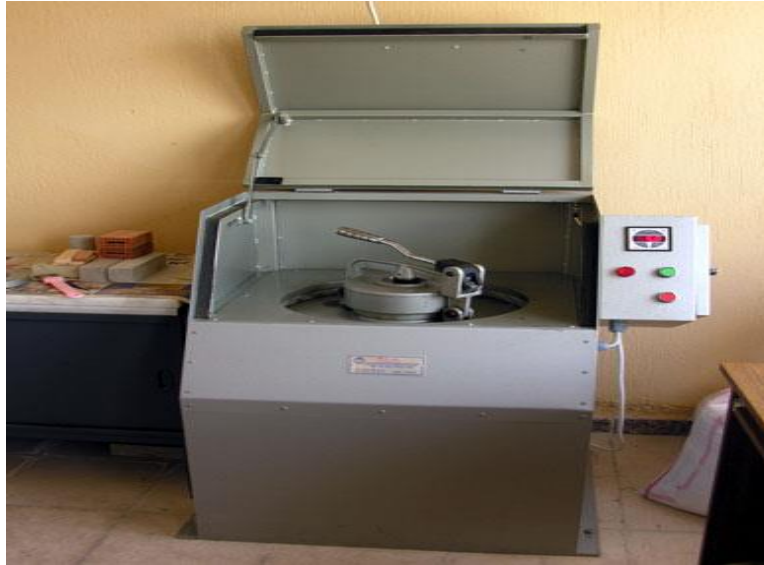
Resim 3.5 AKÜ Maden Mühendisliği Cevher Hazırlama ve Zenginleştirme Laboratuvarında bulunan Ünal Mühendislik marka halkalı değirmen.
