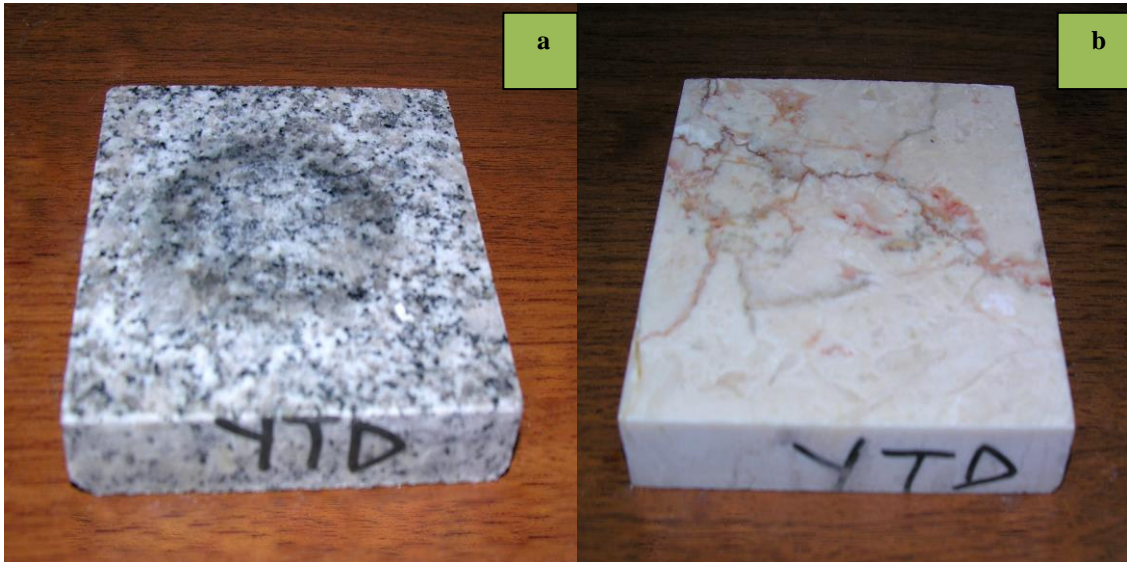
Şekil 4.170 840 saat süre boyunca %100 derişimli yüzey temizleyicisi kimyasalına temas eden granit numunesi (a); 840 saat süre boyunca %100 derişimli yüzey temizleyicisi kimyasalına temas eden mermer numunesi (b).
