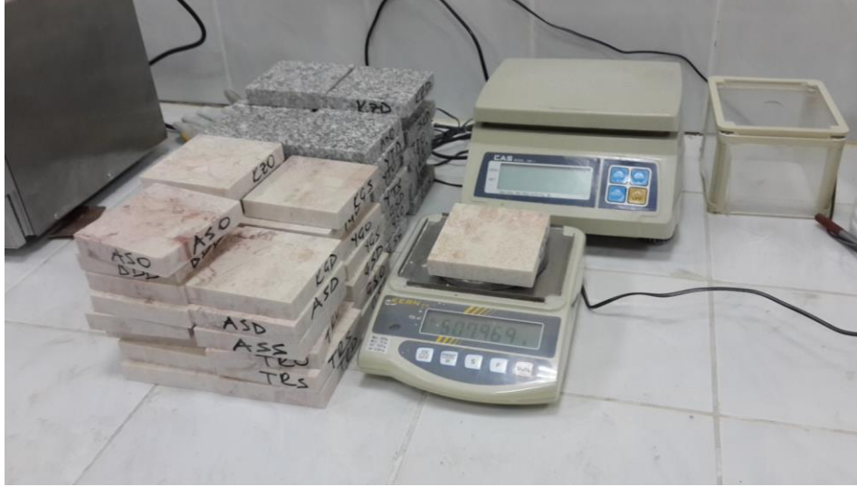
Resim 3.13 AK-DAL'daki Kern marka hassas terazi ( \pm 0,001 gr hassasiyetli).
