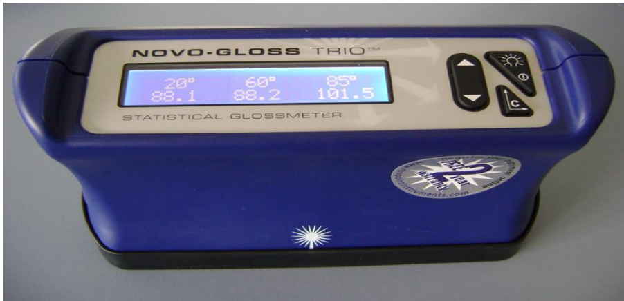
Resim 3.12 AKÜ-DAL’ daki Novo Gloss Trio marka parlaklık ölçüm cihazı.
