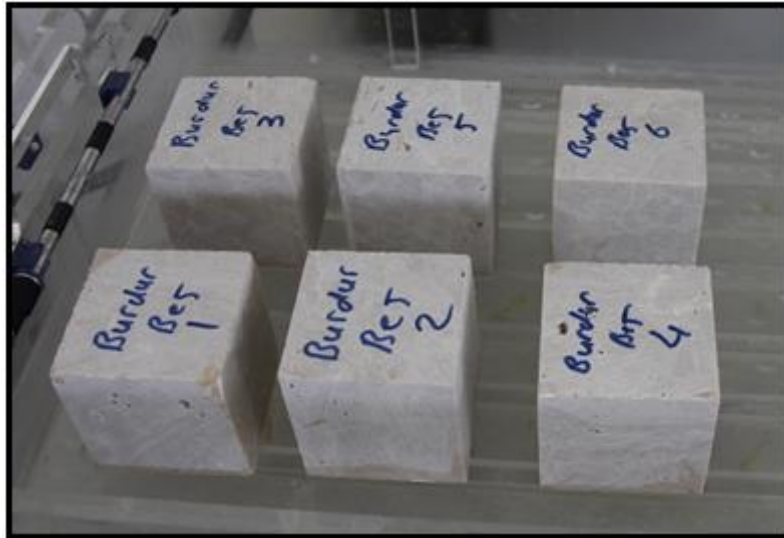
Şekil 3.10 Doğaltaşlarda kılcal su emme deneyi.
