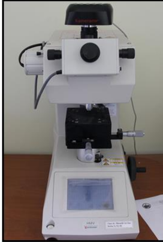
řekil 3.16 Shimadzu HMV Knoop sertlik olcml cihazı.
