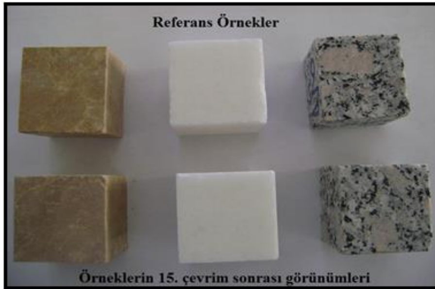
Şekil 3.15 Tuz kristallenmesine direncin tayini deneyi örneklerinin deney öncesi ve sonrası görünümü.
