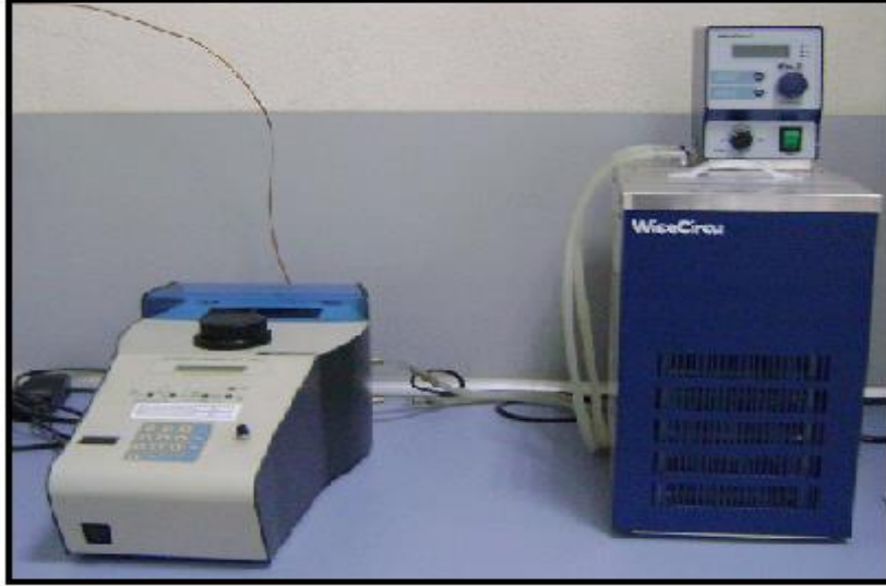
Şekil 3.11 Otomatik yoğunluk ölçüm cihazı (Helyum Piknometresi).
