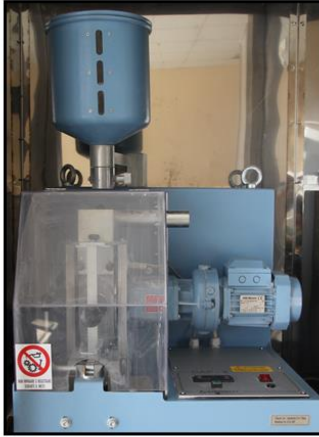
Şekil 3.17 Gabrielli Aşınma dayanım test cihazı.
