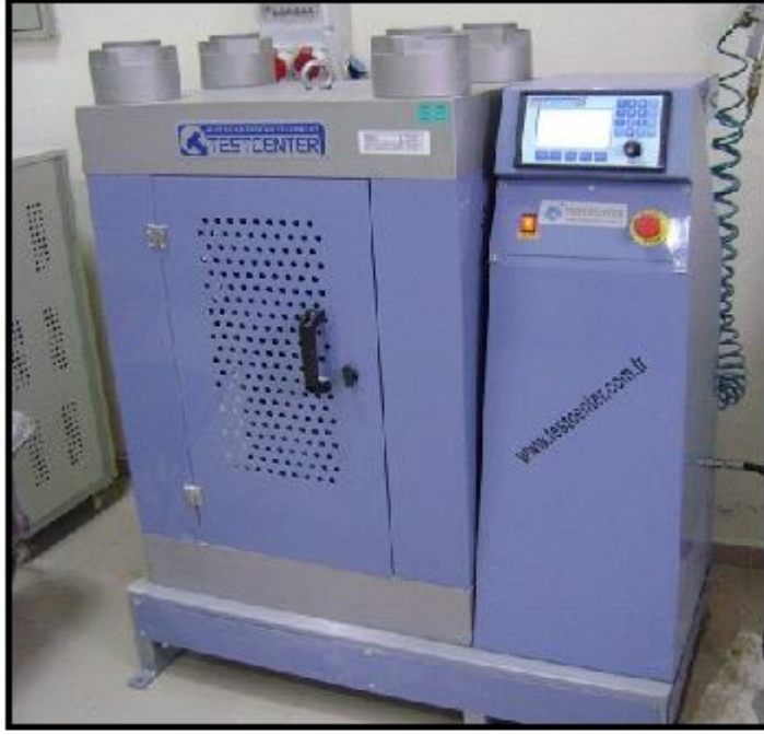
Şekil 3.12 Tek eksenli basınç dayanım deneyi cihazı.
