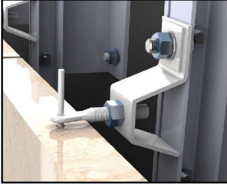
Şekil 2.4 Doğaltaşlarda pim ve kanca kullanımı (İnt. Kyn.4).
