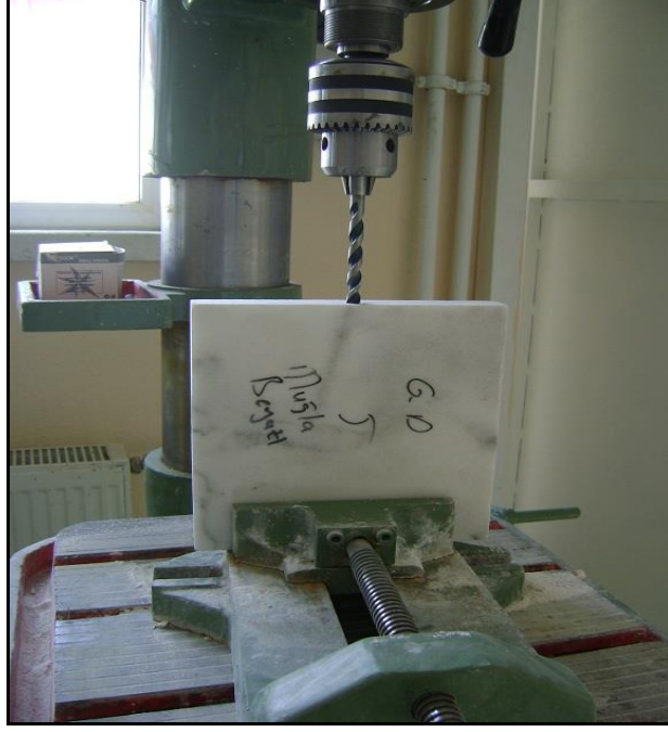
Şekil 3.4 Saplama deliğinin açılması.
