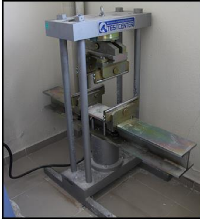
Şekil 3.13 Eğilme dayanım deneyi cihazı.
