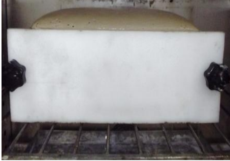
Resim 2.3 Gazbeton harcının etüvde kabarması.
