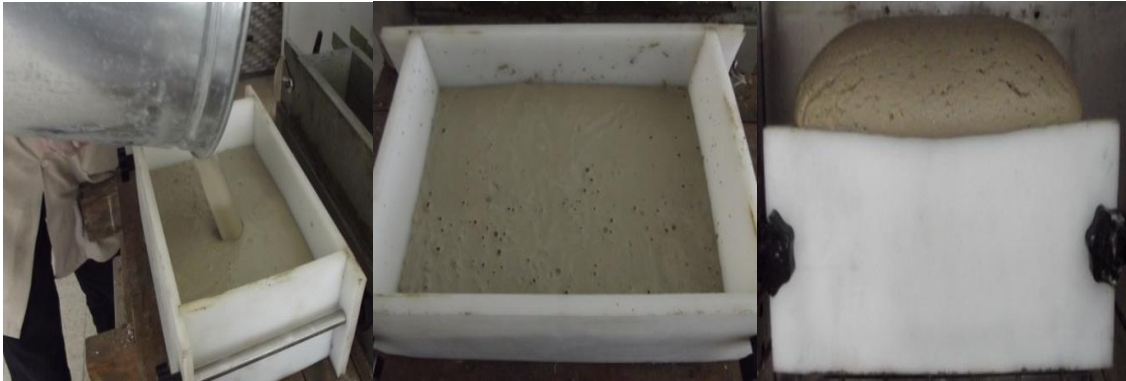
Resim 3.5 Gazbeton harcının kalıba dökülmesi, kabarma öncesi ve kabarma sonrası görünümü.
