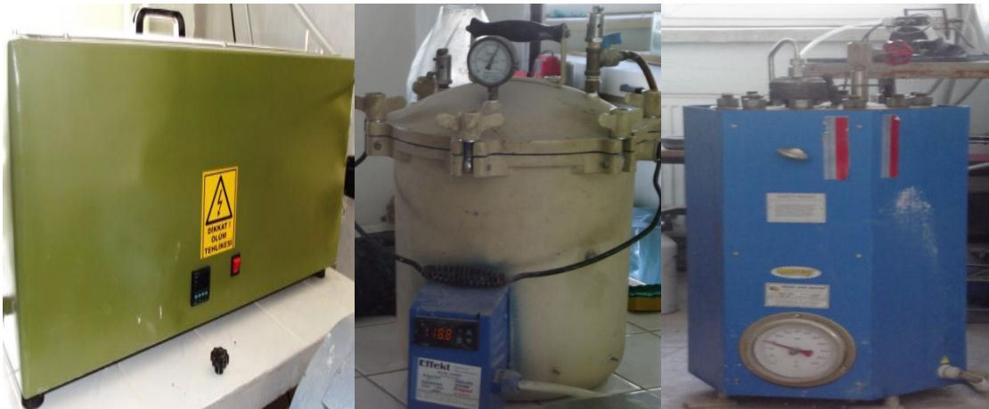
Resim 3.7 Atmosferik buhar kürü (Solda), Düşük basınçta otoklav kürü (Ortada), Otoklav kürü görünümü (Sağda).
