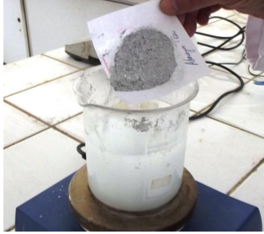
Resim 3.4 Dispersan katkı ve alüminyum tozunun karıştırılması.
