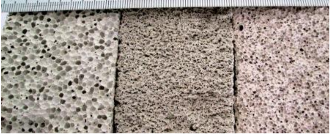
Resim 4.5 Ticari gazbeton (solda), %0,005 polimer katkıli örnek (ortada), %0,003 polimer katkıli örnek (sağda). Not: Büyüklük skalası 1mm'dir.
