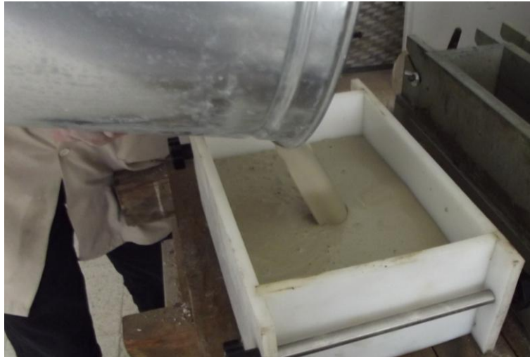
Resim 2.2 Gazbeton harcının kalıba dökülmesi.
