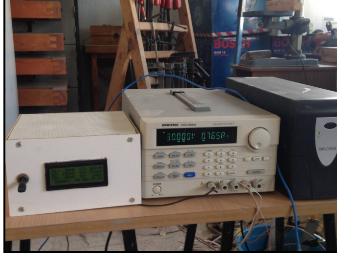
Resim 3.11 Numuneler üzerinden geçen akımları ölçen devre.
