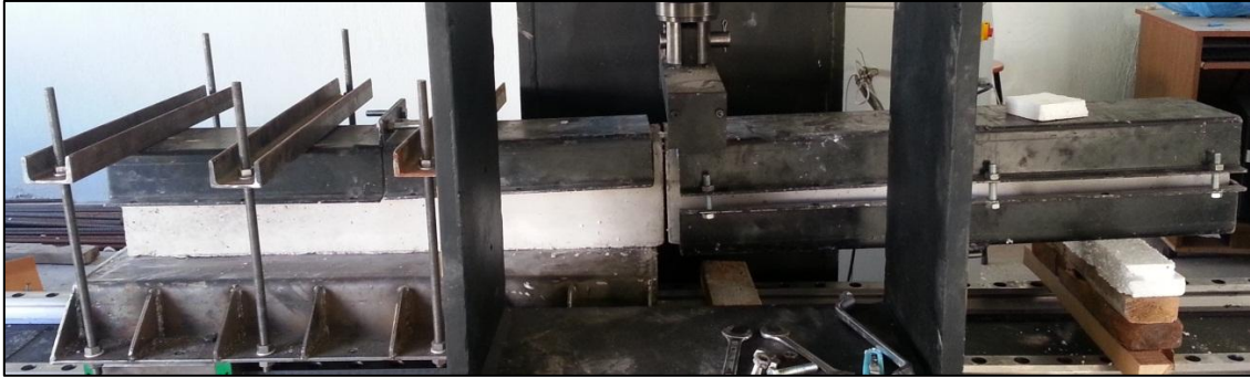
Resim 3.8 Tez çalışmasında kullanılan beton numuneler için çelik kılıflar
