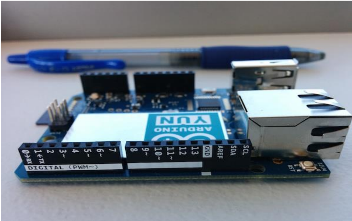
Şekil 3.26 Arduino kartının pin girişleri.
