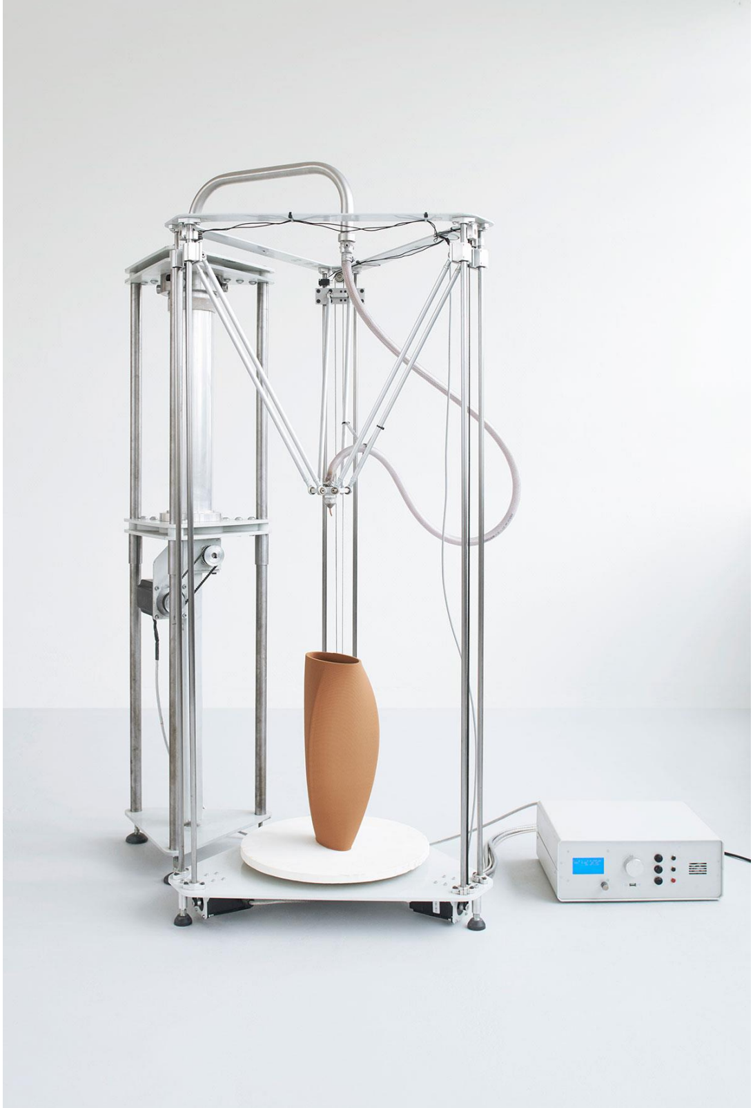
Şekil 37. Olivier Van Herpt, Cos x Olivier Van Herpt Series, 2017, Üç Boyutlu Yazıcı ile Porselen Üretimi
