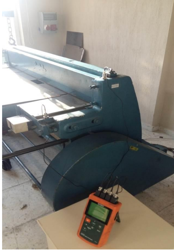
Şekil 3.11 Tezgaha ölçme cihazının bağlantısı.
