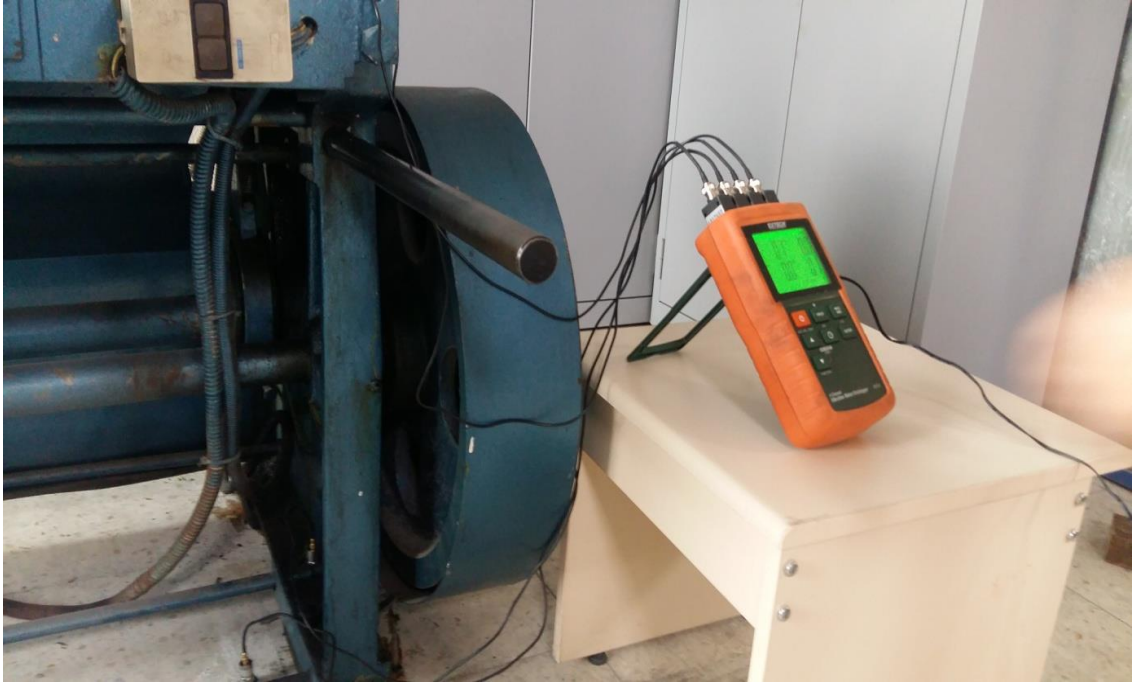
Şekil 4.2 Dört kanallı titreşim ölçme cihazı.
