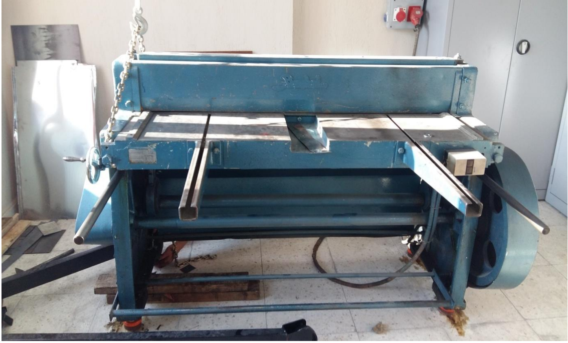
Şekil 4.1 Tezgah ayaklarına takozların yerleştirilmesi.
