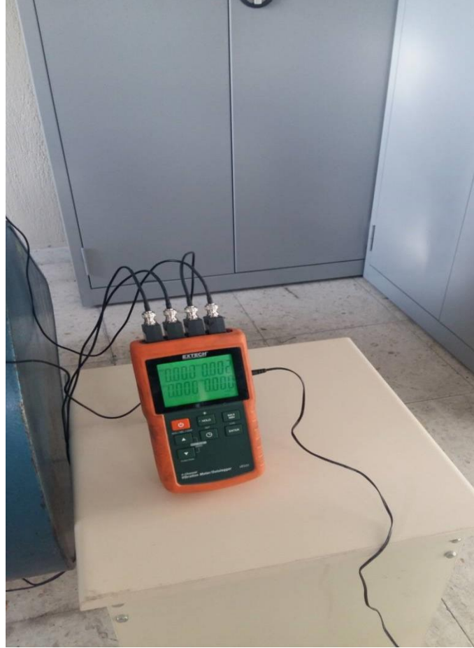
Şekil 4.3 Dört kanallı titreřim ölçme ile titreřim deęerlerinin alınması.
