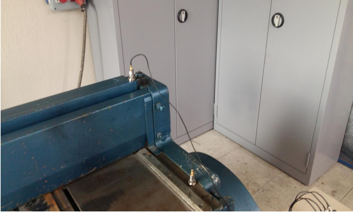
Şekil 3.12 Tezgah üzerine sensorların bağlanması.
