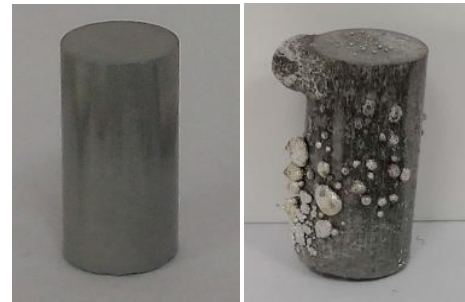
Şekil 5. (a) 550°C (18dk boyunca) ve (b) 570°C (21dk boyunca) sinterlenmiş kompozit numunelerin dış görünüşleri
