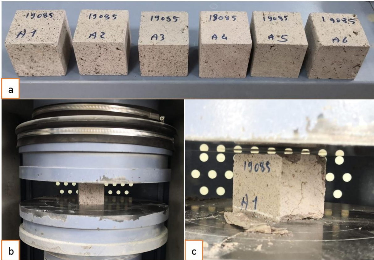
Şekil 8. Tuz buharıyla yıpranmaya karşı direncin tayini deneyi sonrası numunelerin görünüşü (a), Tek eksenli basınç dayanımı deneyi (b), Tek eksenli basınç dayanımı sonrası numunenin görünüşü (c)
