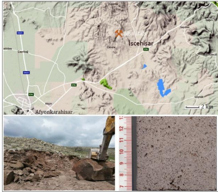
Şekil 2. Deneylerde kullanılan andezitin üretildiği ocakların lokasyon haritası, ocağın ve andezitin yüzey görünümü
