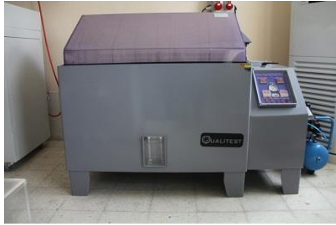
Şekil 3. Tuz buharıyla yıpranmaya karşı direncin tayini test kabini
