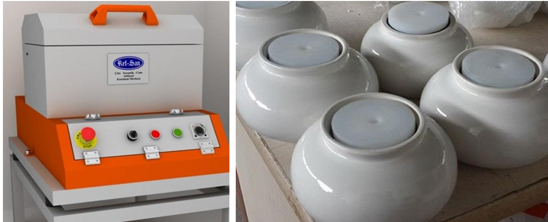
Şekil 3.2 Toz karıştırmada kullanılan jet değirmen ve porselen kavanozlar.
