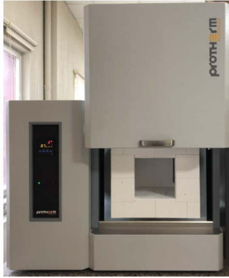
Şekil 3.8 Sinterleme için kullanılan yüksek sıcaklık fırını.
