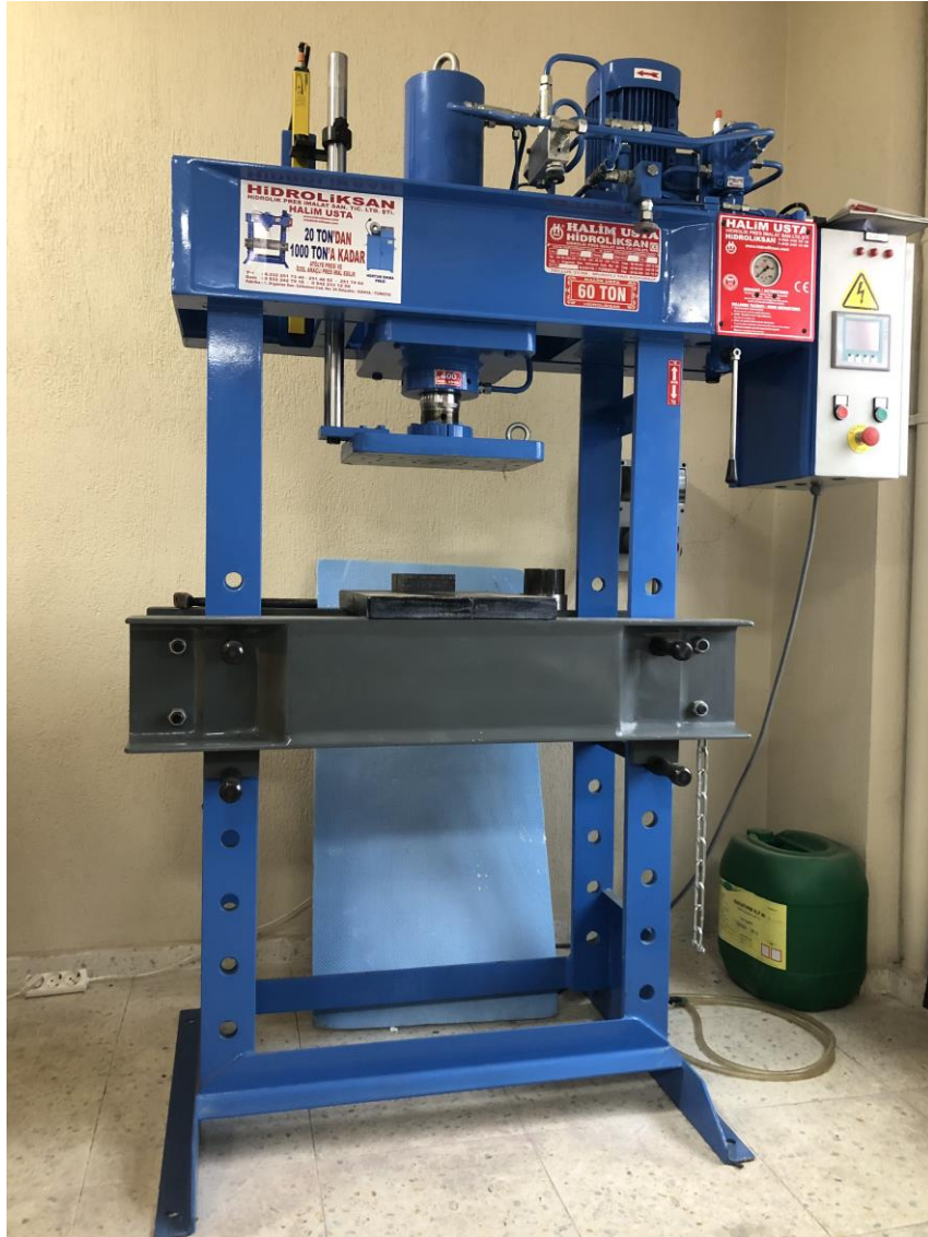
Şekil 3.7 Şekillendirme için kullanılan hidrolik pres.
