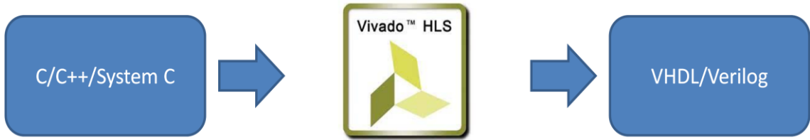
Şekil 3.13 Vivado Yüksek Seviyeli Sentez kod dönüşümleri.
