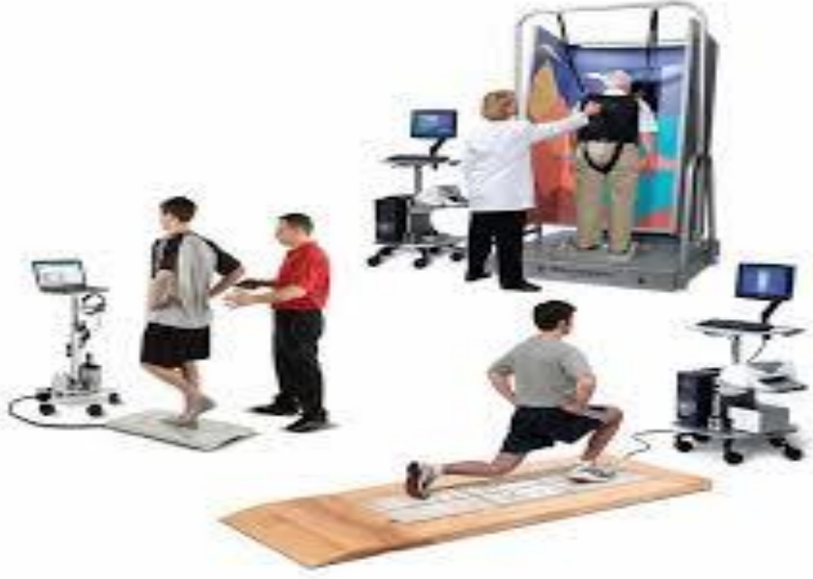
Şekil 2.10 Postürografi cihazı (İnt. Kyn. 3).
