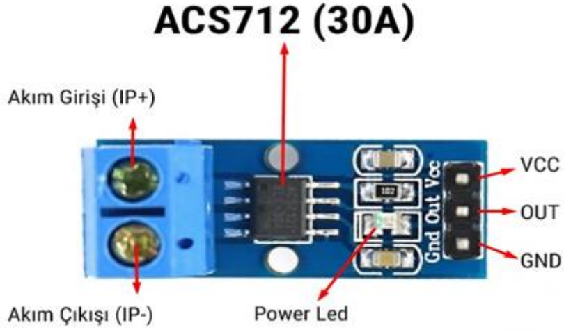
Şekil 3.6 Akım sensörünün pin diyagramı (İnt. Kyn. 9).
