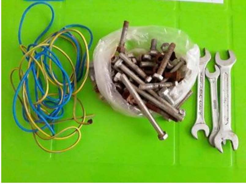
Resim 3.6 Sistemde kullanılan birleştirme elemanları.
