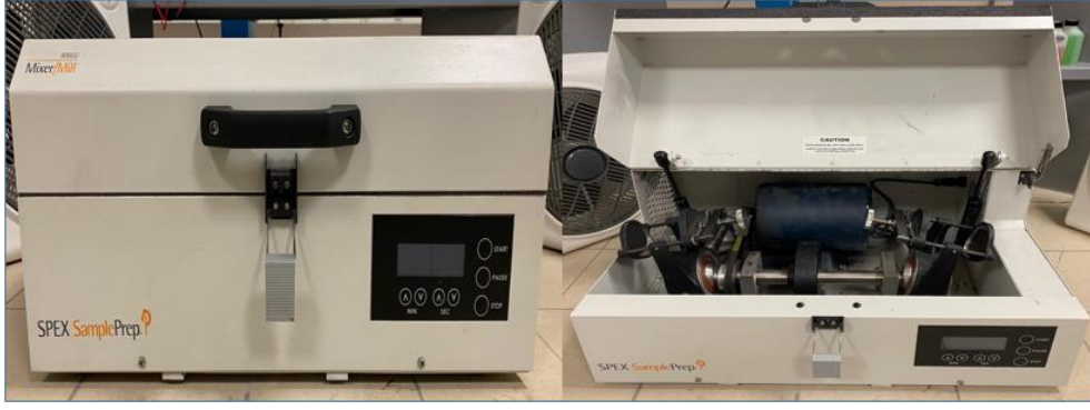
Resim 4.2 Mekanik Alaşımlama işlemi için kullanılan SPEX™ Değirmen.
