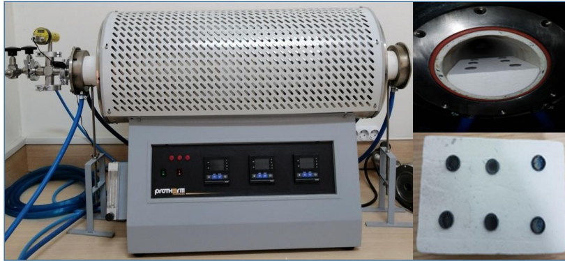
Resim 4.6 Sinterleme işlemi için kullanılan atmosfer kontrollü Tüp Fırın.
