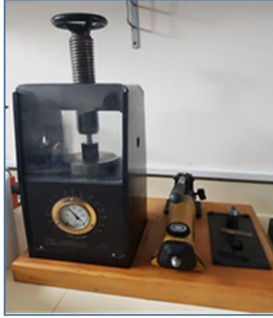
Resim 4.5 Tozların preslenmesinde kullanılan tek eksenli Hidrolik Pres.
