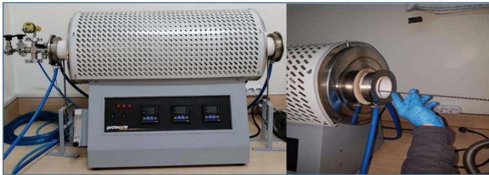
Resim 4.4 Bağlayıcı giderme işlemi için kullanılan Atmosfer kontrollü Tüp Fırın.
