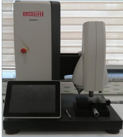
Resim 4.8 Numunelerin sertlik ölçümlerinde kullanılan Vickers Mikro Sertlik Cihazı.
