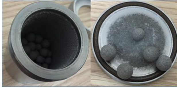
Resim 4.3 Mekanik Alaşımlamada kullanılan kaplardaki (vial) soğuk yapışma.
