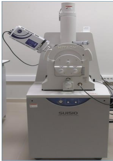
Resim 4.7 Mikroyapısal incelemede kullanılan Taramalı Elektron Mikroskobu.
