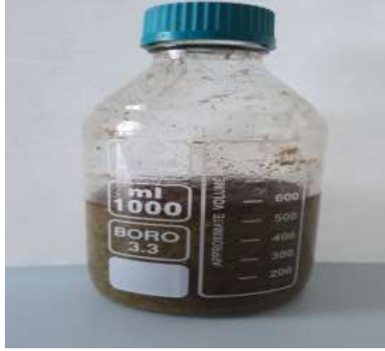
Resim 3.2 Çözücü ile toz haline getirilmiş bitkinin ekstaksiyon sırasındaki karışımı.
