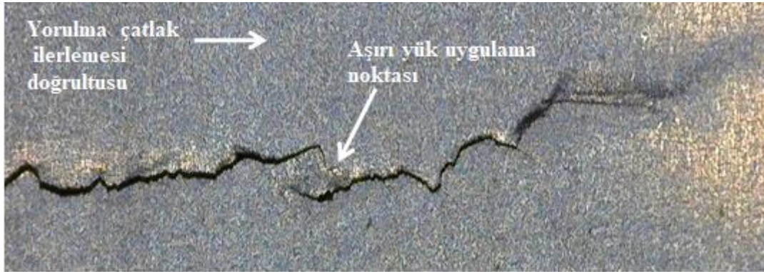
Şekil 6.40 Solüsyona alınmış numunede 1,3 oranında aşırı yük sonrasında çatlağın davranışına ait USB mikroskop görüntüsü.
