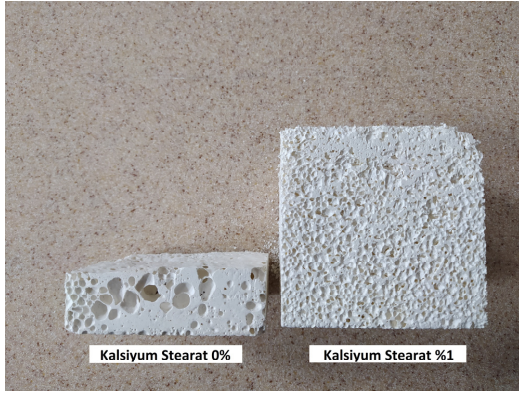
Şekil 3. Köpük düzenleyici olarak kullanılan Kalsiyum Stearat’ın etkisi.
