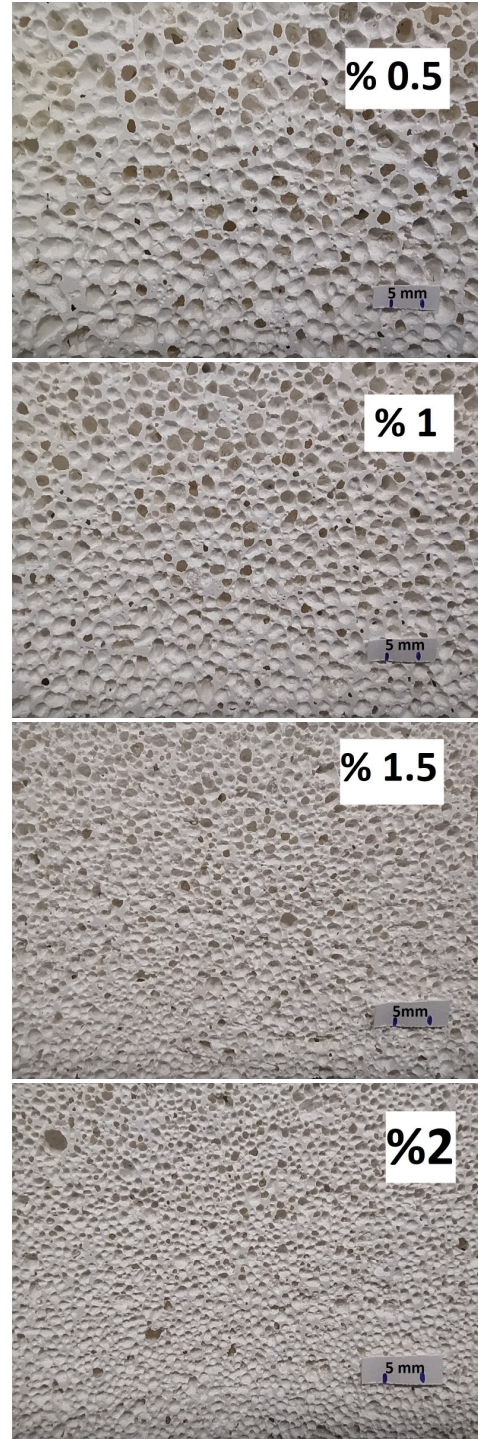
Şekil 4. Kalsiyum stearat miktarına göre değişen gözenek boyut ve dağılımı.
