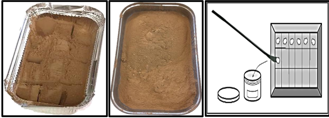
Resim 3.8 Kareleme yöntemiyle örnek alma işlemi.
