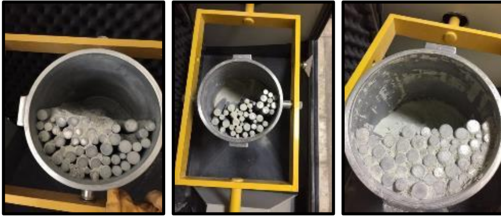
Resim 3.18 Laboratuvar ölçekli çubuklu değirmene çubuk ve numune şarj görüntüsü.
