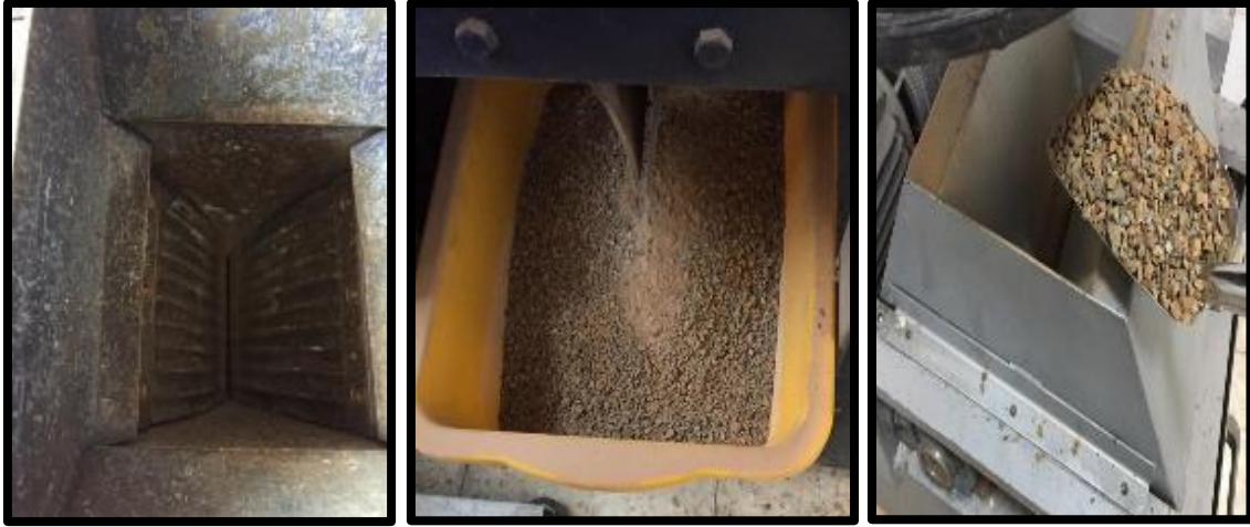
Resim 3.14 Çeneli kırıcı ağız açıklığı ve kırıcıdan çıkan cevher boyutu.
