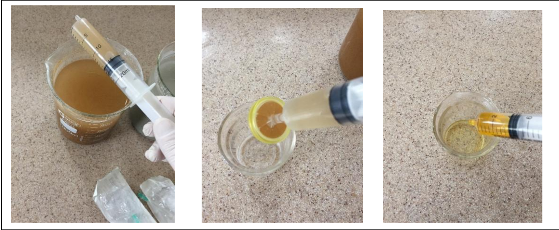
Resim 3.28 20 ml’lik şırınga yardımıyla liç testinden örnek alımı.
