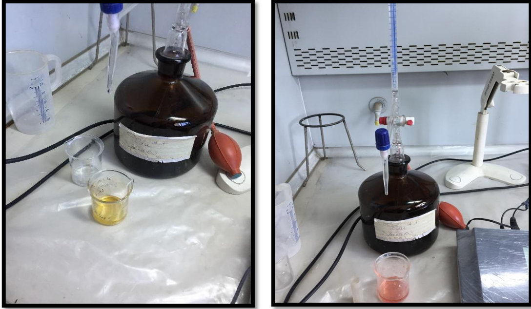
Resim 3.39 Gümüş nitrat titrasyonunda serbest siyanür ölçme işlemi.
