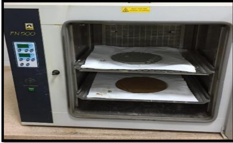
Resim 3.37 Katı-sıvı ayırma işlemi sonrası Nüve FN 500 marka etüvde kurutulan katı numuneler.
