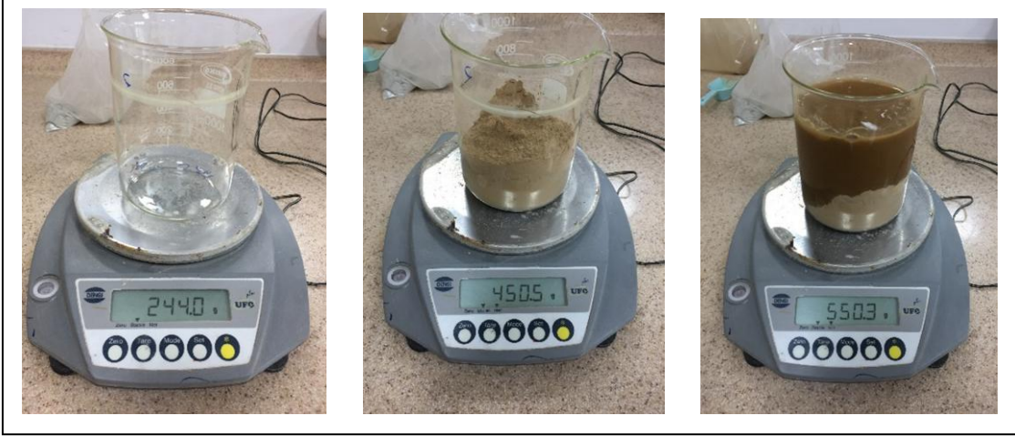
Resim 3.27 Kaymaz cevherinin %45 katı oranlı liç hazırlığı.
