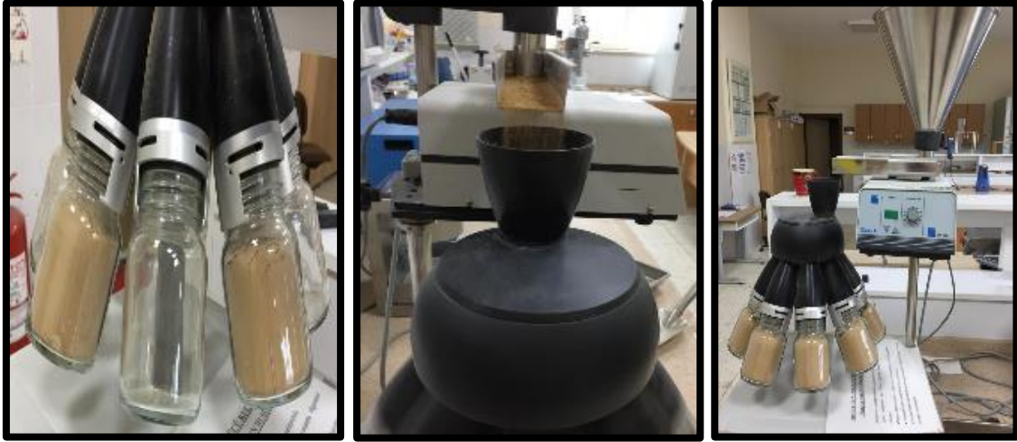
Resim 3.25 Kaymaz cevherinin PT 100 kavanozlu numune bölücüde örnek alma işlemi.
