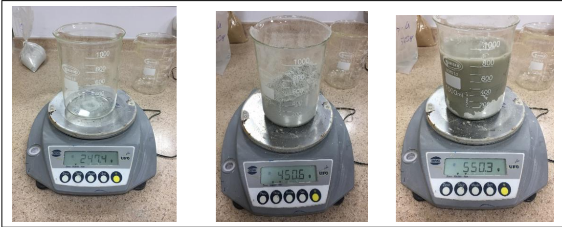
Resim 3.26 Çukuralan cevherinin %45 katı oranı liç hazırlığı.
