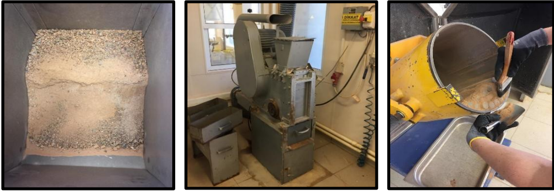
Resim 3.10 Boyut küçültmede kullanılan laboratuvar tip çeneli kırıcı ve çubuklu değirmen.
