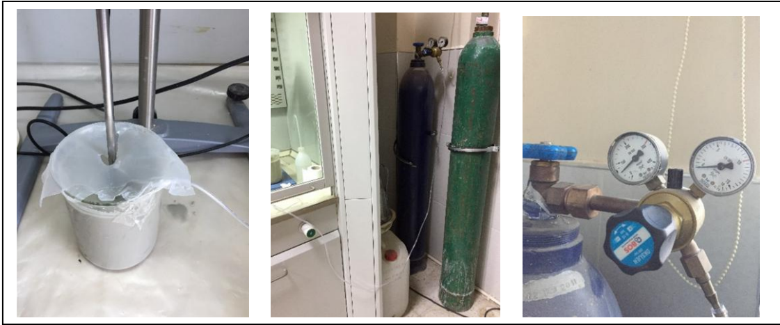
Resim 3.30 Oksijen ilavesi işlemi.
