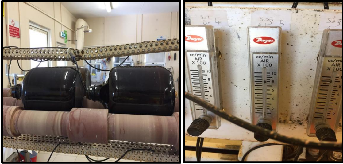
Resim 4.3 Bottle roll düzeneği ve O 2 rotametre ayarları.
