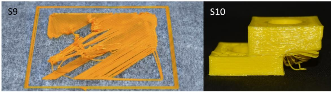
Resim 4.4 Katmanların üretiminde karşılaşılan sorunlar; ilk katmanda adezyon sorunu (S9), katman kaymaları (S10).
