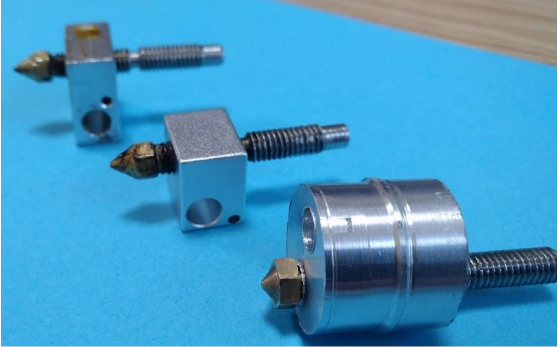
Şekil 4.35 Mevcut ısıtma modülü tasarımları ve önerilen tasarım.
