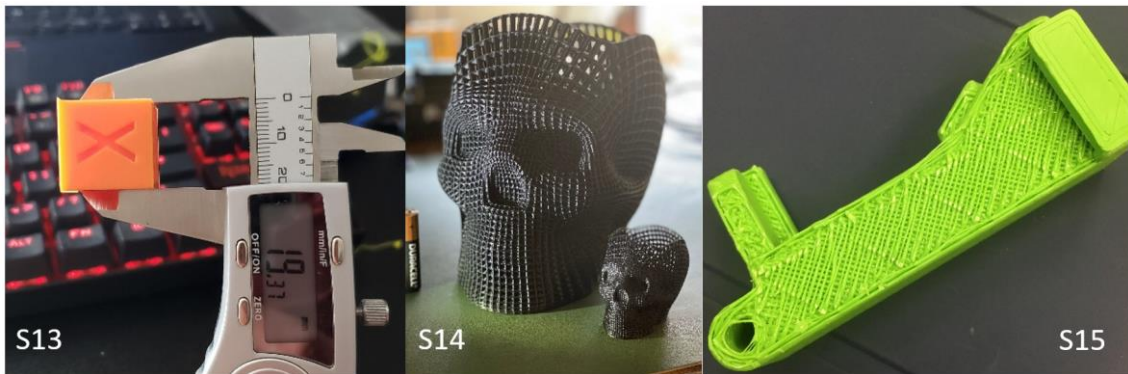
Resim 4.6 Ekstruder ve tolerans sorunları; tolerans sorunları (S13), küçük detayların üretim sorunları (S14), destek yapıların neden olduğu sorunlar (S15).
