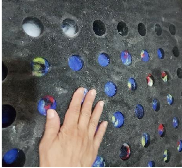
Şekil 67. Rulo keçenin deliklere sıkıştırılması.
