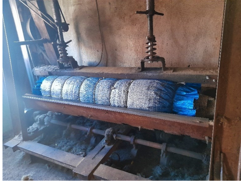
Şekil 36. Hasıra sarılmış yünün makinede tepilmesi.
