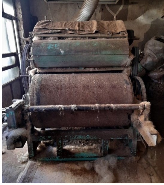
Şekil 29. Erkuş keçe kepenek atölyesinde bulunan hallaç makinesi.
