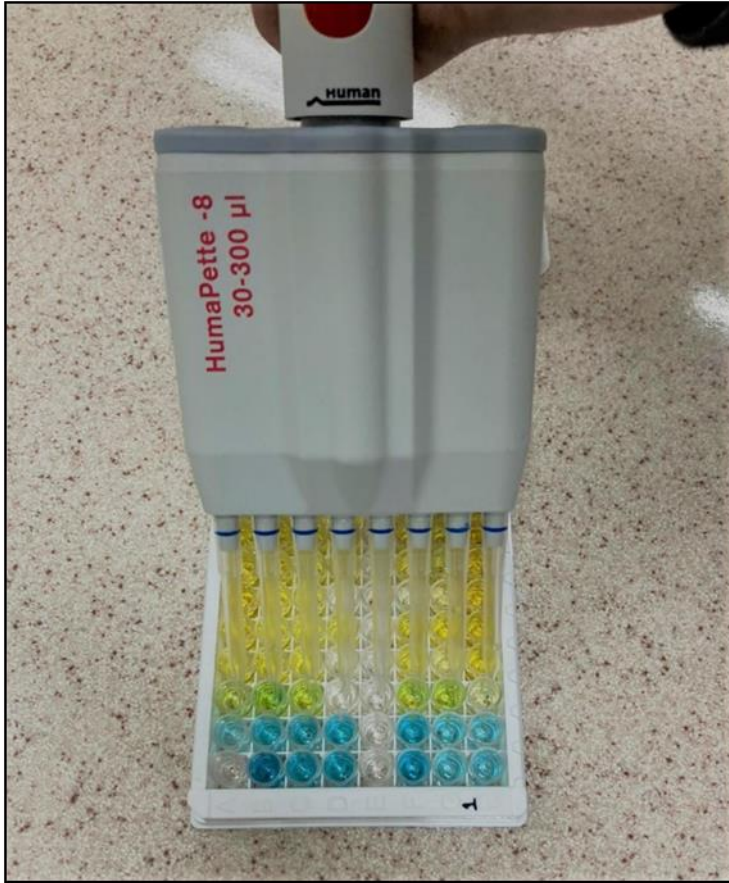
Resim 2.5: C- Reaktif Protein örneklerinin multi pipetler aracılığıyla kuyucuklara doldurulması
