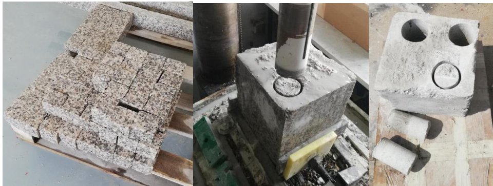
Şekil 3.34 Fiziko mekanik testlerde kullanılan numunelerin hazırlanması.
