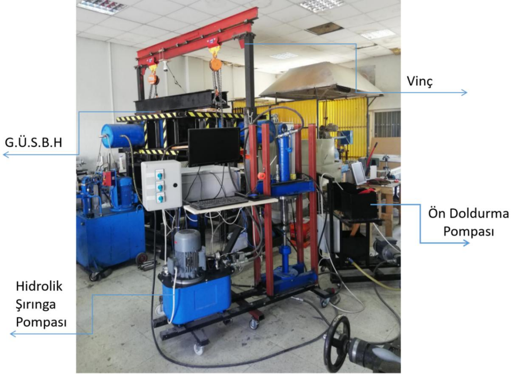
Şekil 4.4 Hidrolik çatlatma deney düzeneği.
