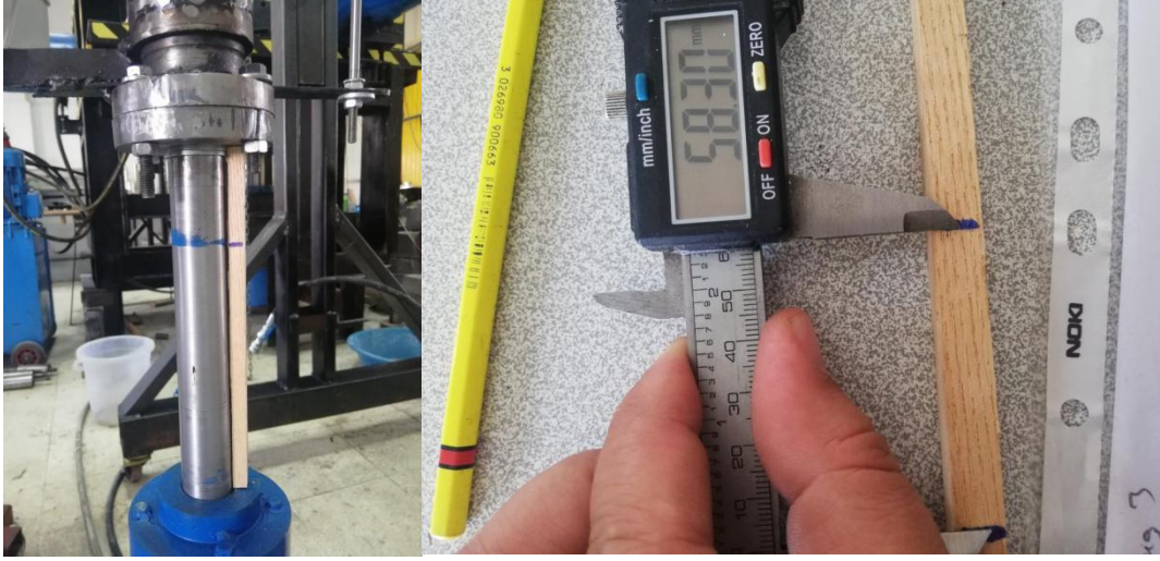
Şekil 4.12 Konum değişikliğinin elle ölçülmesi.
