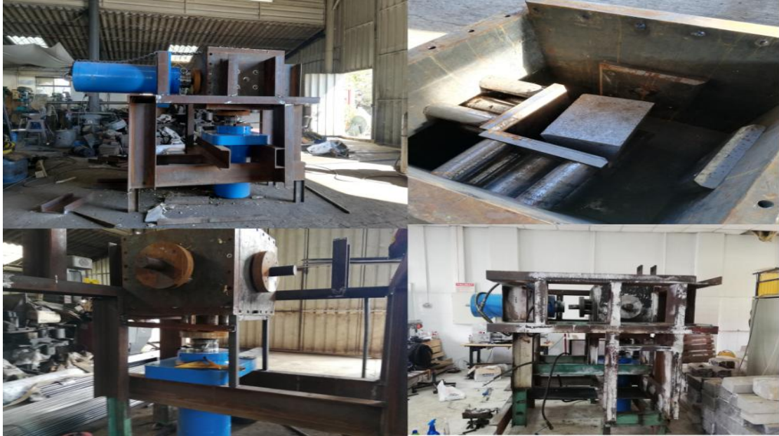
Şekil 3.16 Gerçek üç eksenli basınç ve sıcaklık hücresi üretimi.
