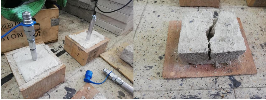
Şekil 3.28 Ön çatlatma deneylerinde kullanılan alçı örnekleri.
