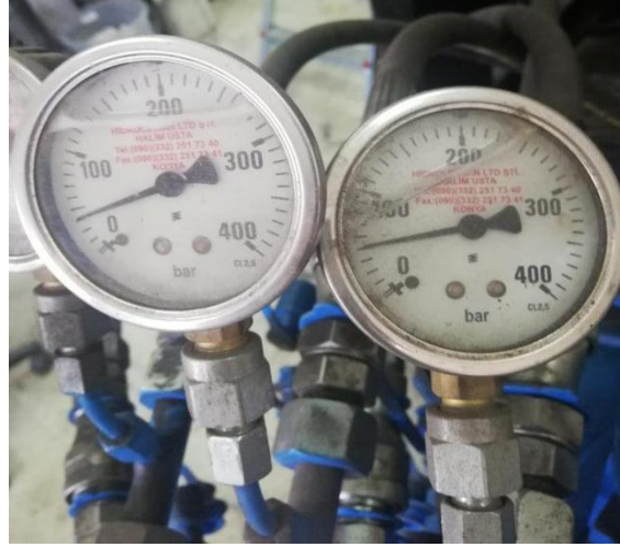
Şekil 3.33 Eksenel basınçların ayarlanması.
