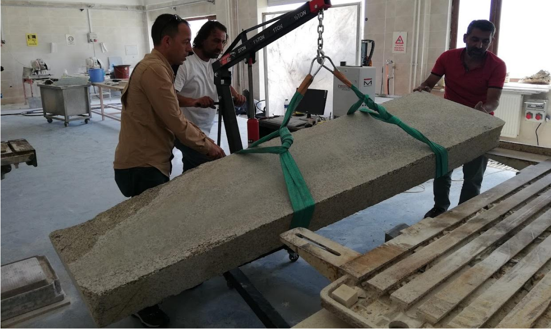
Şekil 3.24 Parçanın tezgâha yerleştirilmesi.
