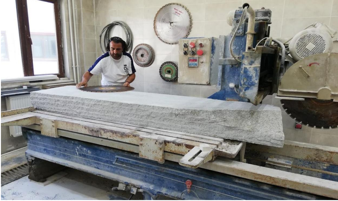
Şekil 3.25 Granit parçasının boylamasına ikiye bölünmesi.
