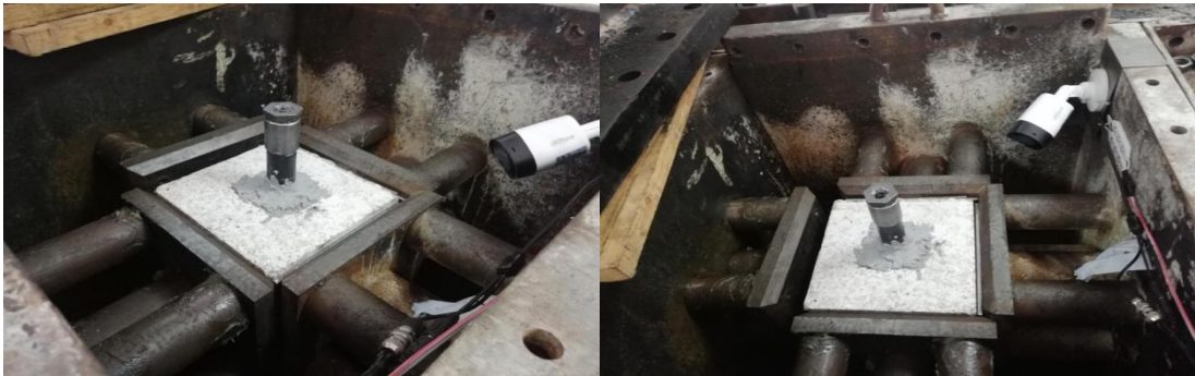
Şekil 3.31 Kayaçların basınç hücresine yerleştirilmesi.
