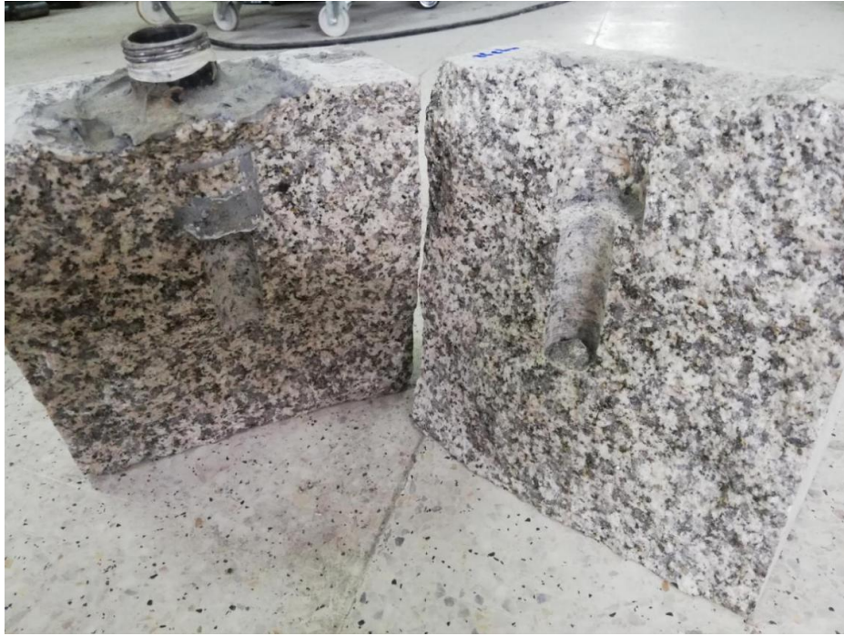
Şekil 4.22 Çatlatılmış granit numunesinin kesiti.
