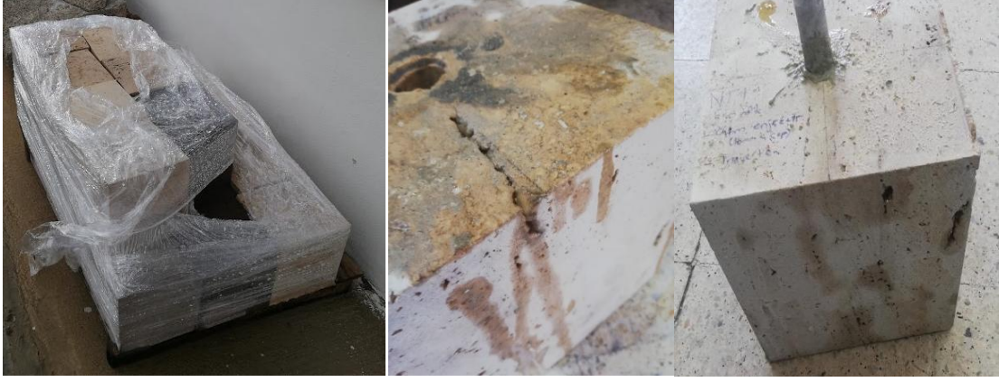
Şekil 3.22 Ön çatlatma deneylerinde kullanılan traverten örnekleri.
