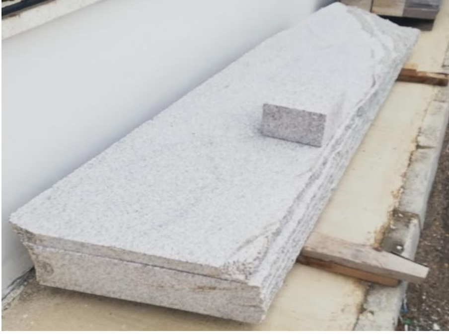
Şekil 3.23 Deney örnekleri için temin edilen kapak altı granit parçaları.
