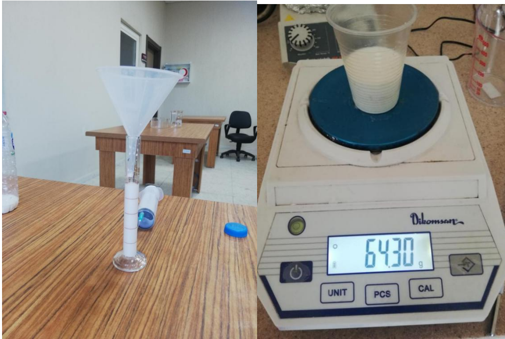
Şekil 4.16 Çatlatma sıvısı hacim ve ağırlık ölçümleri.
