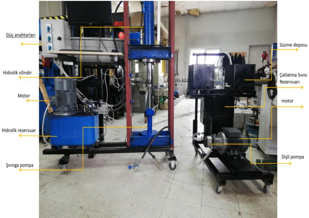
Şekil 3.3 Hidrolik çatlatma pompası.
