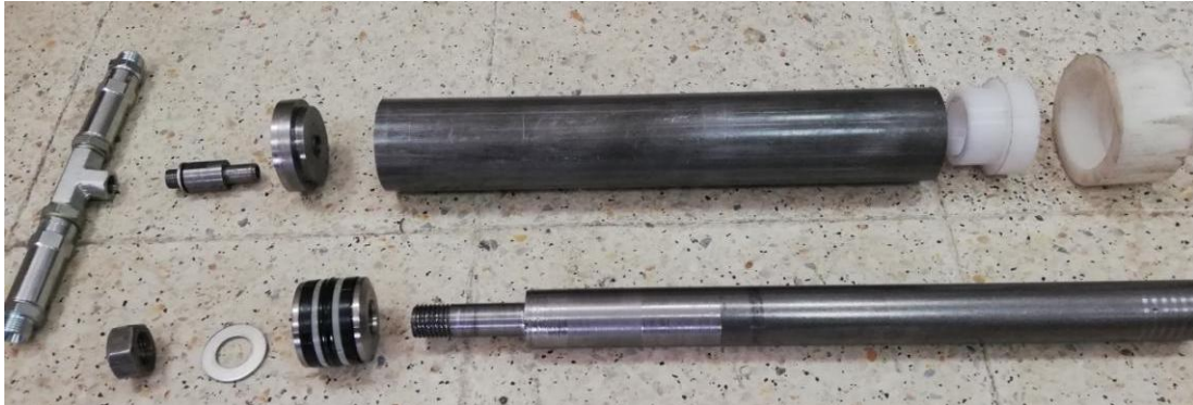
Şekil 3.9 Piston (şırınga) pompa iç parçaları.
