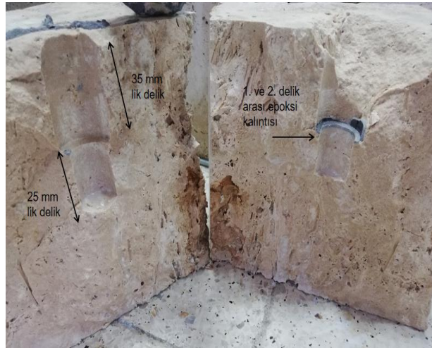
Şekil 4.8 Üst delik ve çatlatma odasının traverten üzerinde gösterimi.
