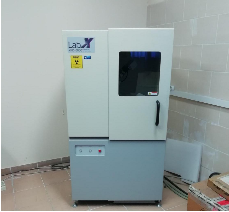
Şekil 3.37 Shimadzu XRD-6000 model X-ışını difraktometre cihazı.
