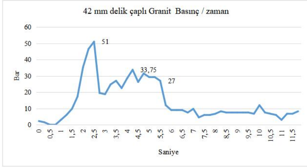
Şekil 4.23 42 mm çaplı delik ve basınç boşluklu granit çatlatma deneyi basınç / zaman grafiği.
