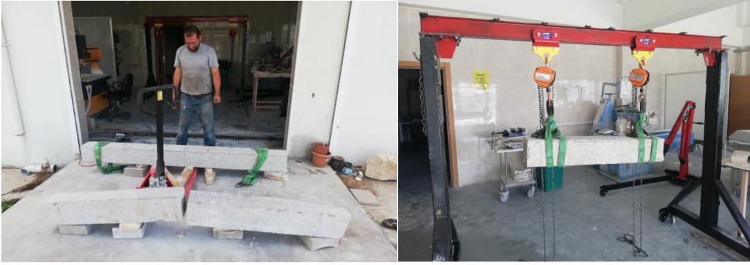
Şekil 3.26 Boydan ebatlama işlemi ve parçaların taşınması.
