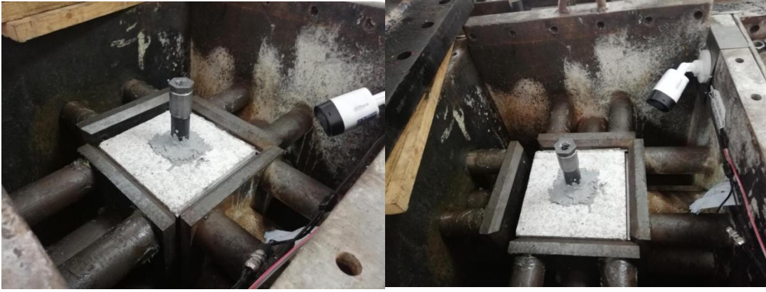
Şekil 4.6 Kayaç sıkıştırma basınç oluşturma işlemleri.
