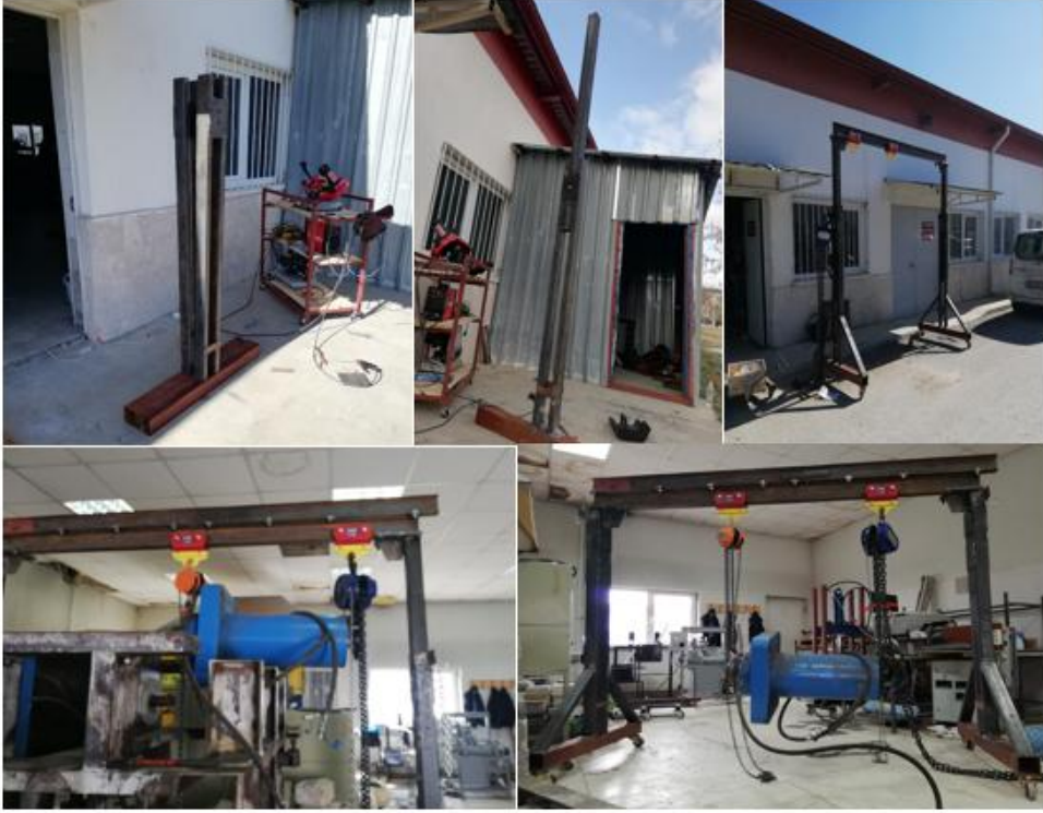
Şekil 3.20 Vincin imalatı ve kullanılması.
