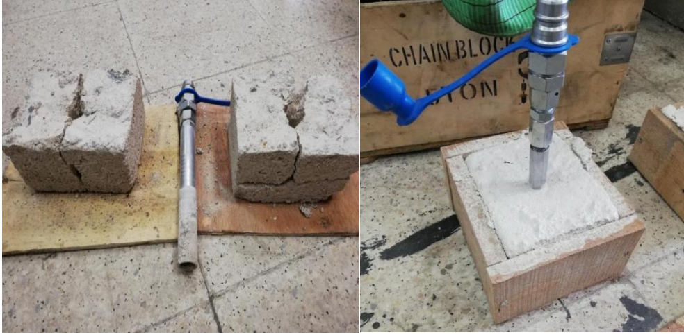
Şekil 3.10 Alçı ve beton kalıpların çatlatılması.
