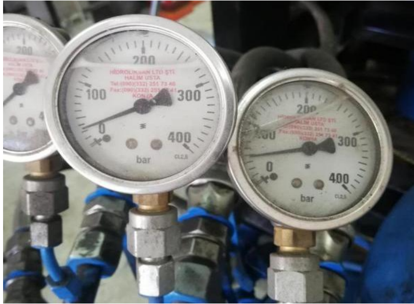
Şekil 4.5 Hücre içindeki kayaca tatbik edilen aksenal basınçlar.
