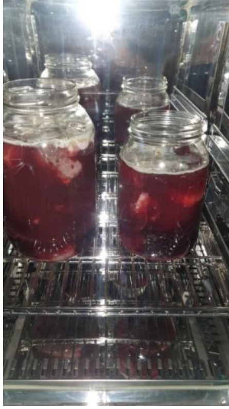
Resim 2.3: Böbreklerin KOH çözeltisi içinde etüvde bekletilmesi
