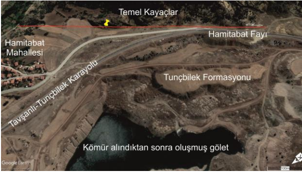
Şekil 3. Saha çalışmaları sırasında tespit ettiğimiz KD-GB doğrultulu sol yanal oblik normal Hamitabat Fayı. Fay, Üst Kretase yaşlı temel kayaçlar ile Miyosen yaşlı Tunçbilek Formasyonu'nu birbirinden ayırmaktadır (35S/713777D/4391628K).
