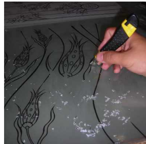
Resim 89. Serigrafi İçin Film Hazırlama: Filmler Üzerinden Renk Ayrımının Elde Yapılması
