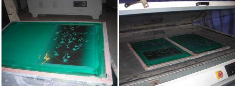
Resim 93. Elek Pozlandırma Aşaması: Filmlerin Uygun Elekler Üzerine Yerleştirilip Sabitlenmesi
