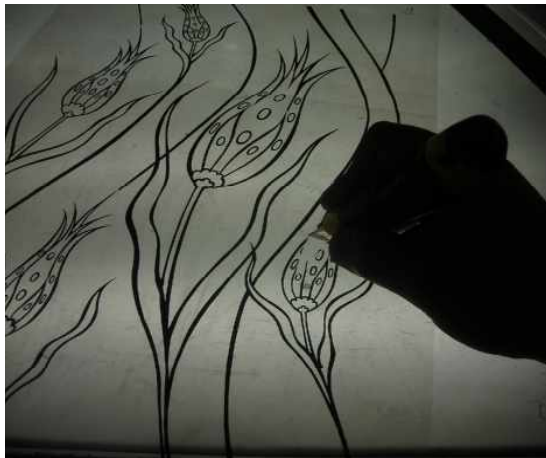
Resim 89. Serigrafi İçin Film Hazırlama: Filmler Üzerinden Renk Ayrımının Elde Yapılması
