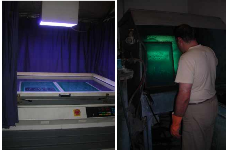
Resim 94. Elek Pozlandırma Aşaması: Pozlandırma ve Elek Açma
