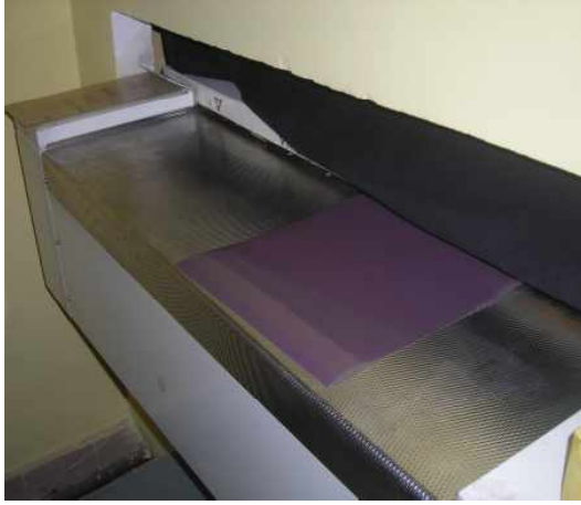
Resim 88. Serigrafi İçin Film Hazırlama: Pozlandırılan Filmin Banyo Yapılması
