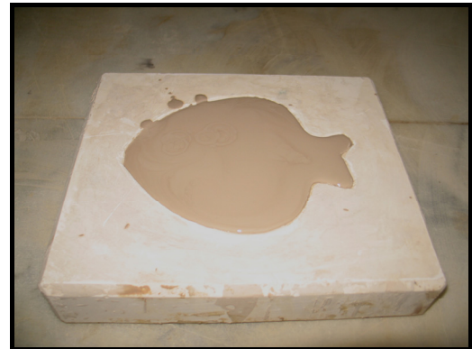
Resim 15-16. Çini Çamurunun Alçı Kalıplara Dökülmesi
