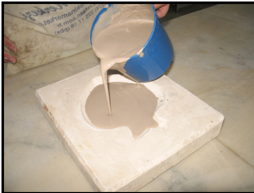
Resim 15-16. Çini Çamurunun Alçı Kalıplara Dökülmesi
