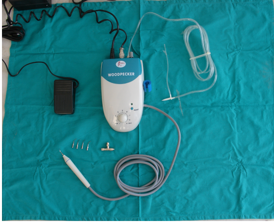
Resim 2. 1: Diş taşı temizleme de kullanılan ultrasonik kazıyıcı
