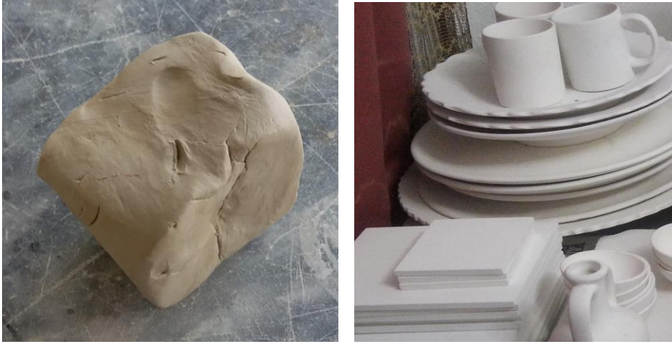
Resim 17. Akçini Çamurunun Yaş ve İlk Pişirimi Yapılmış Şekilleri 960 °C (Karademir, 2017)
