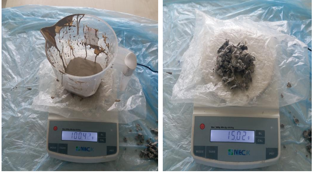
Resim 102. Akçini Çamuruna Karıştırılan Gazete Kağıdının Oranlarının Gösterilmesi(Karademir, 2018)
