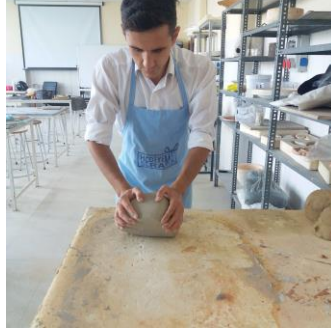
Resim 101. Döküm Çamurunun Alçı Masada Yoğrulması (Karademir, 2018)
