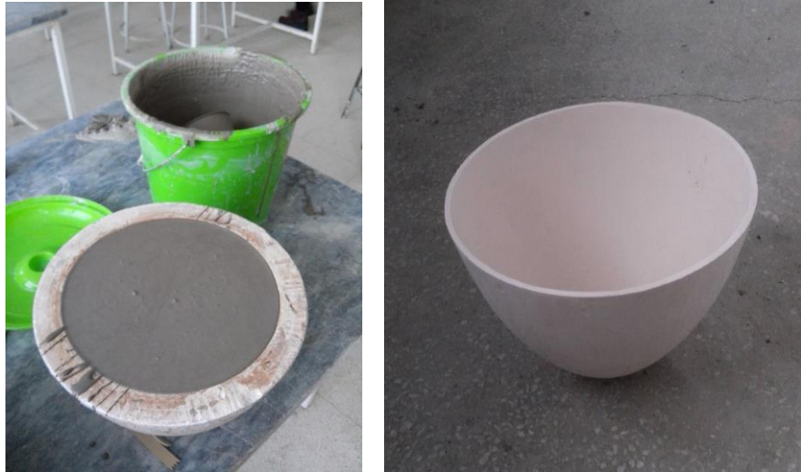
Resim 18. Döküm Çamurunun Yaş ve İlk Pişirimi Yapılmış Şekli 1000 °C (Karademir, 2017)
