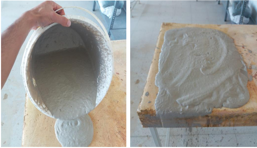
Resim 103. Kağıt Katkılı Akçini Çamurunun Alçı Masaya Yayılması (Karademir, 2018)
