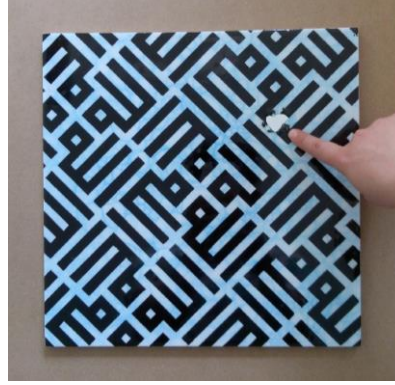
Resim 93. Sorunlu Bünye ve Sır Uyumsuzluğu (Karademir, 2017)
