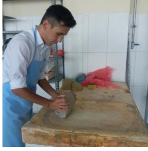
Resim 104. Kağıt Katkılı Akçini Çamurunun Alçı Masada Yoğrulması (Karademir, 2018)
