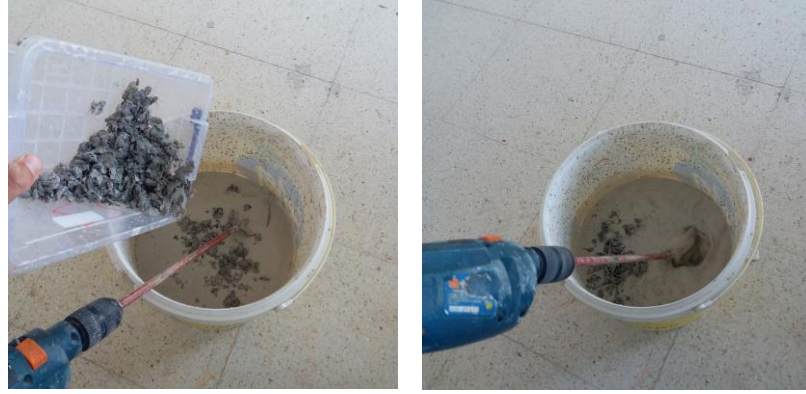
Resim 99. Döküm Çamurunun Gazete Kağıtları ile Karıştırılması (Karademir, 2018)
