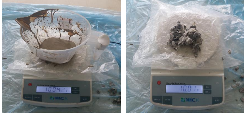
Resim 131.Porselen Çamuruna Karıştırılan Gazete Kağıdının Oranlarının Gösterilmesi (Karademir, 2018)
