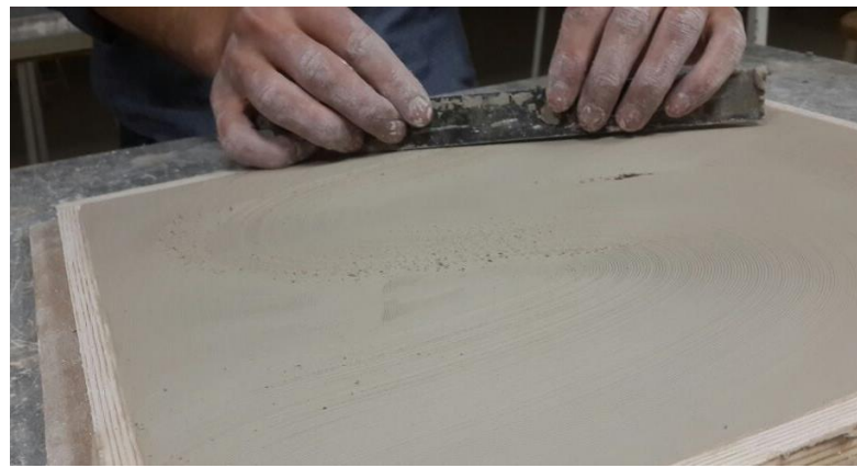
Resim 63. Plastik Kıvamdaki Döküm Çamurunun Plaka Basımı (Karademir, 2017)
