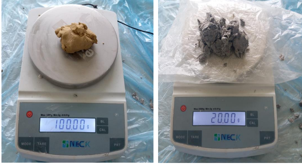
Resim 124. Şamot Çamuruna Karıştırılan Gazete Kağıdının Oranlarının Gösterilmesi (Karademir, 2018)
