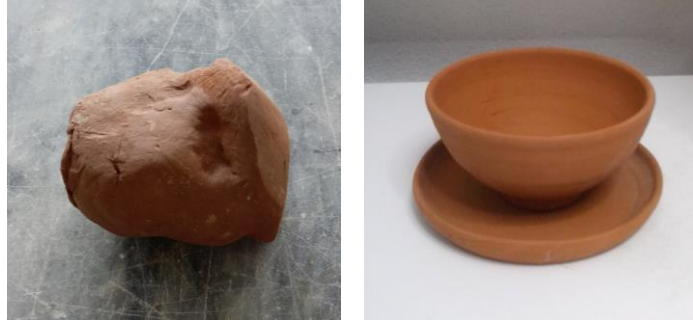
Resim 19. Kırmızı Çamurun Yaş ve İlk Pişirimi Yapılmış Şekli 1000 °C (Karademir, 2017)
