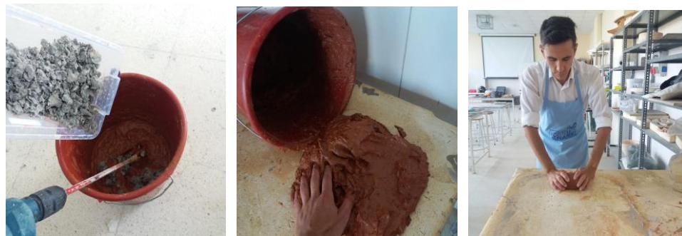
Resim 118. Kağıt Katkılı Kırmızı Çamurun Hazırlanma Aşamaları (Karademir, 2018)
