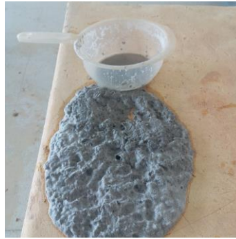
Resim 100. Kağıt Katkılı Döküm Çamurunun Alçı Masaya Yayılması (Karademir, 2018)
