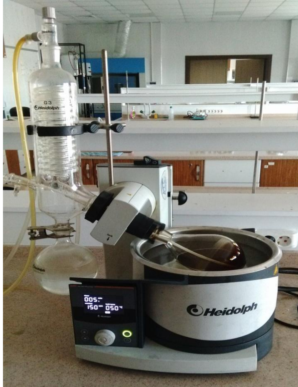
Şekil 3.4 Sıvı Ürününün Çözücüden Ayrılması İşlemi.
