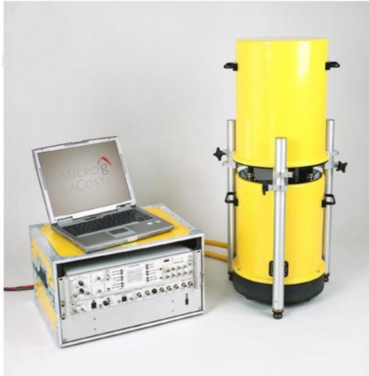
Resim 4.1 Micro-g LaCoste A-10 mutlak gravite ölçer (Aydın 2014).
