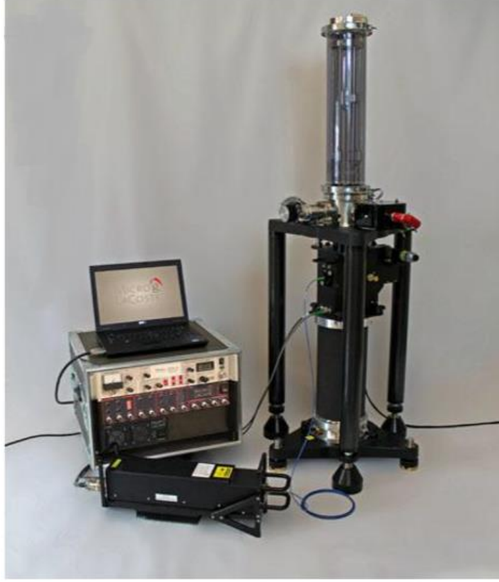
Resim 4.2 Micro-g LaCoste FG5-X mutlak gravite ölçer (Aydın 2014).
