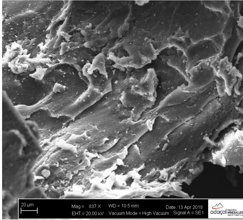
Resim 4.1 Atık lastiğe ait SEM görüntüsü.
