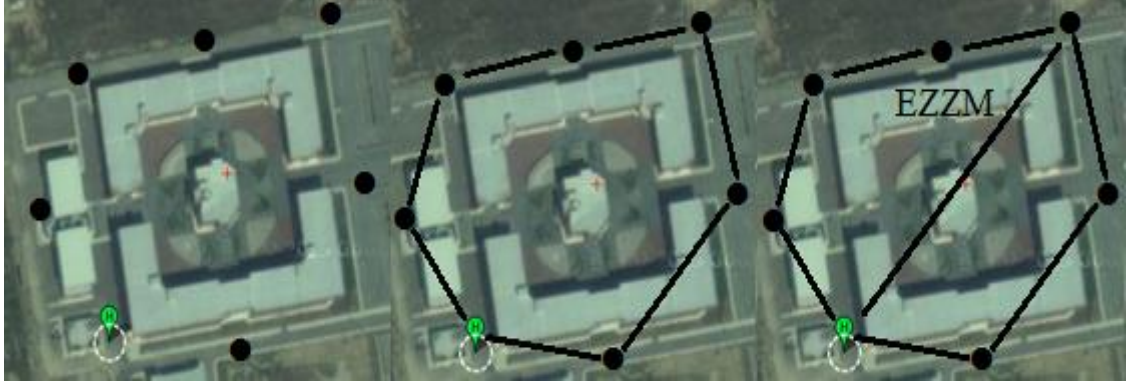
Şekil 3.2 a) Hedef arazideki tüm ziyaret noktaları, b) Tek İHA çifti için hesaplanan İHA yörüngesi, c) hesaplanan İHA yörüngesi üzerinde EZZM.
