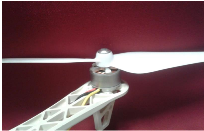
Resim 3.1 MT-İHA'larda kullanılan motor ve pervane.
