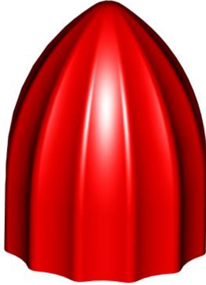
Şekil 4.29 Hidromekanik yöntem ile tek aşamada imal edilebilen bir geometri
