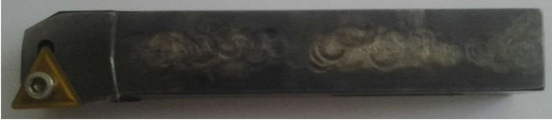
Resim 3.2 TNMG 220408 666X kesici uç ve kateri.
